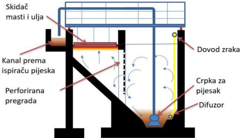
**Slika 4.5.** Shematski prikaz poprečnog presjeka aeriranog pjeskolova-mastolova [8]
