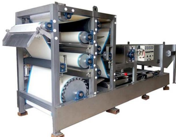
Slika 4.9. Trakasta filter preša [22]
