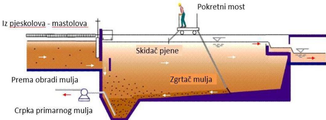
**Slika 4.7.** Shematski prikaz uzdužnog presjeka pravokutnog prethodnog taložnika [8]
