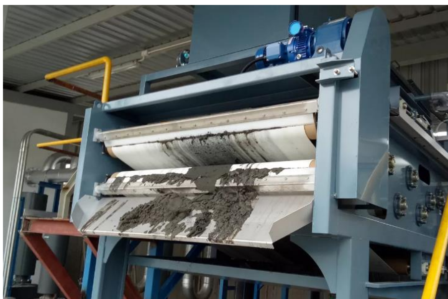
Slika 12: Dehidracija mulja pomoću trakaste filter preše [16]
