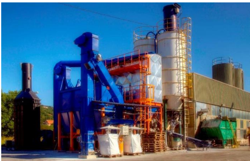
Slika 16: MID-MIX ® postrojenje za solidifikaciju mulja [10]
