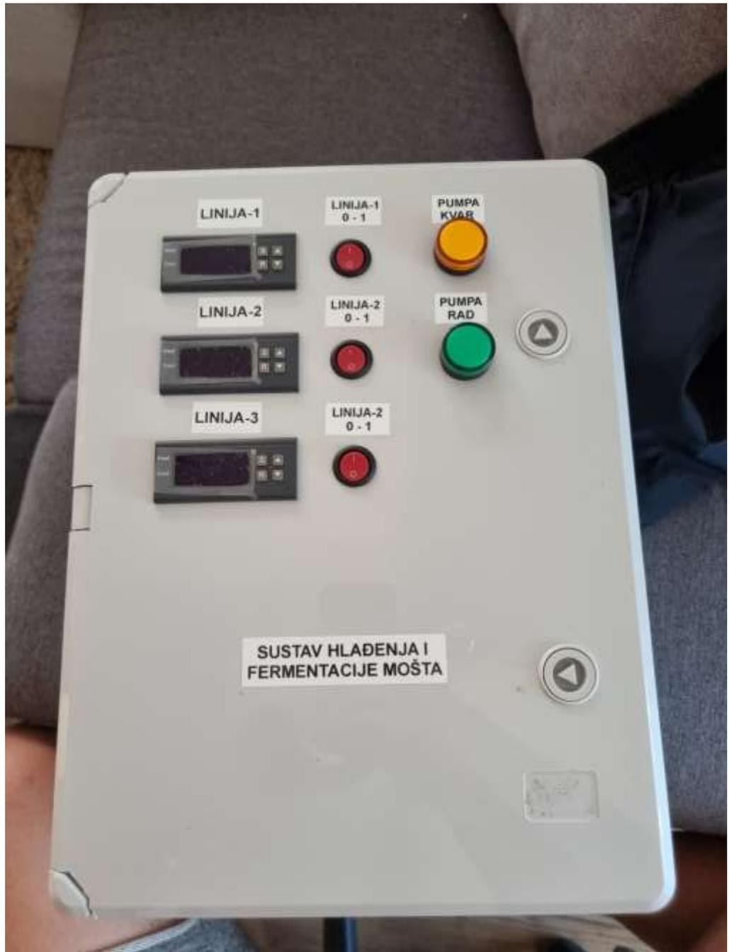
**Slika 4.3. Rashladni sustav smješten u kućište**
