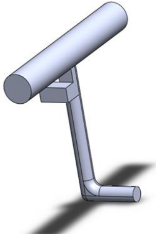
Slika 3.53 3D prikaz igle za orijentiranje čepova
