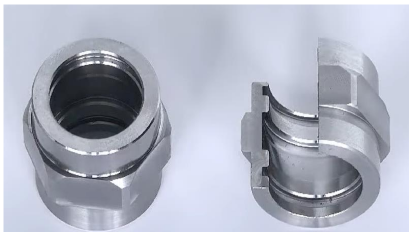
Slika 6.12 Proizvod izrađen višefunkcijskim alatom Iscar DRG-MF [41]
