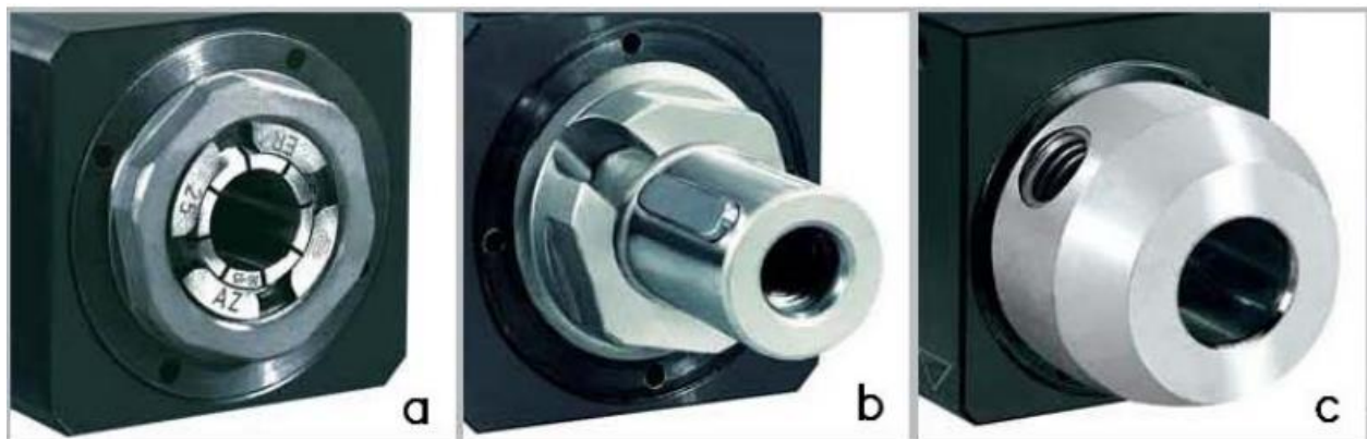
Slika 6.6 Stezanje alata u držač [37]
