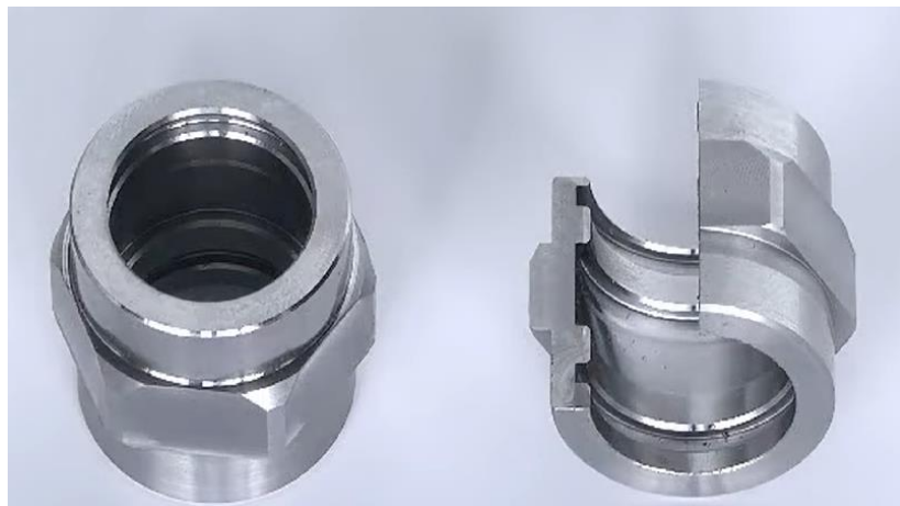
Slika 6.12 Proizvod izrađen višefunkcijskim alatom Iscar DRG-MF [41]
