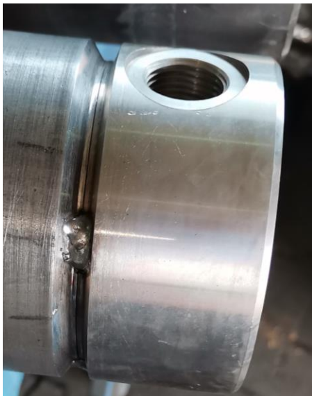
Slika 5.43; Postupak zavarivanja dna i cijevi cilindra [autor - 17.05.2022.]
