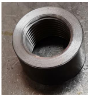
Slika 5.6; Zavareni priključak cilindra 1/2" [autor - 21.04.2022.]
