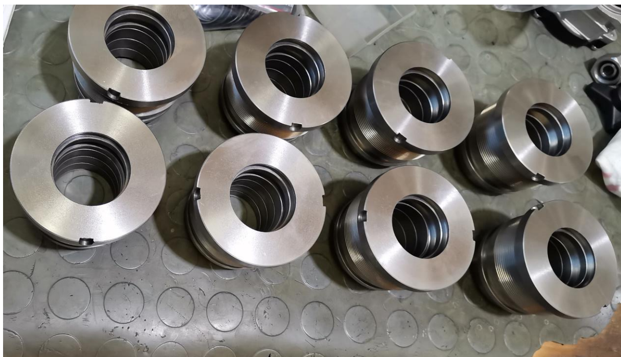
Slika 5.45; Glave cilindara neposredno prije montaže [autor - 19.05.2022.]
