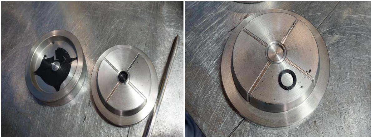
Slika 67 Otvoreni kalup i gotovi proizvod, fotografirano 9.5.2022.
