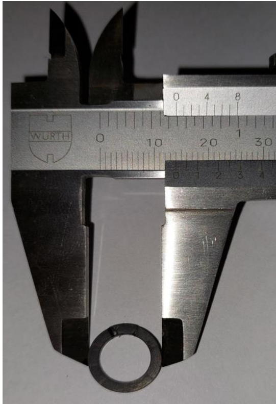
Slika 2 Mjerenje vanjskog promjera brtve, fotografirano 29.4.2022.
