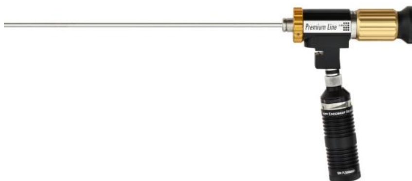
Slika 2.5 Boreskop s krutom cijevi [4]
