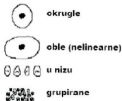
Slika 4.28 Tipovi točkastih indikacija [10]
