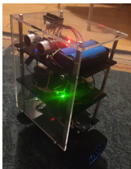
Slika 11.2.Samobalansirajući robot u radu
