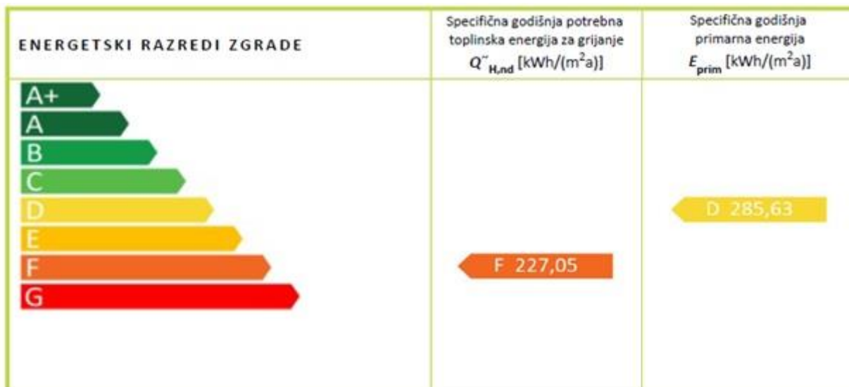
Slika 15 - Prikaz energetskeg certifikata nakon provedene mjere 1
