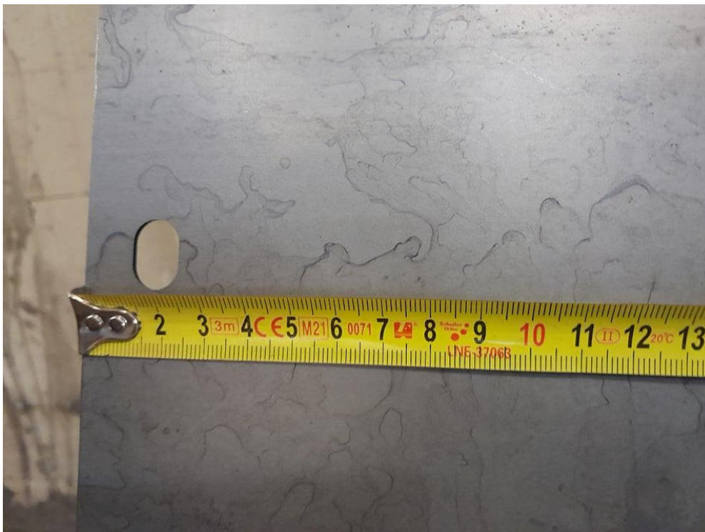
Slika 2.3. Kontrola lima prije savijanja [19]
