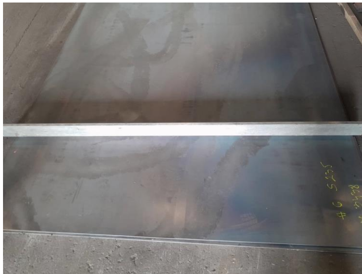
Slika 5.1. Ulazna kontrola ravnosti i dimenzija pristiglog lima[19]
