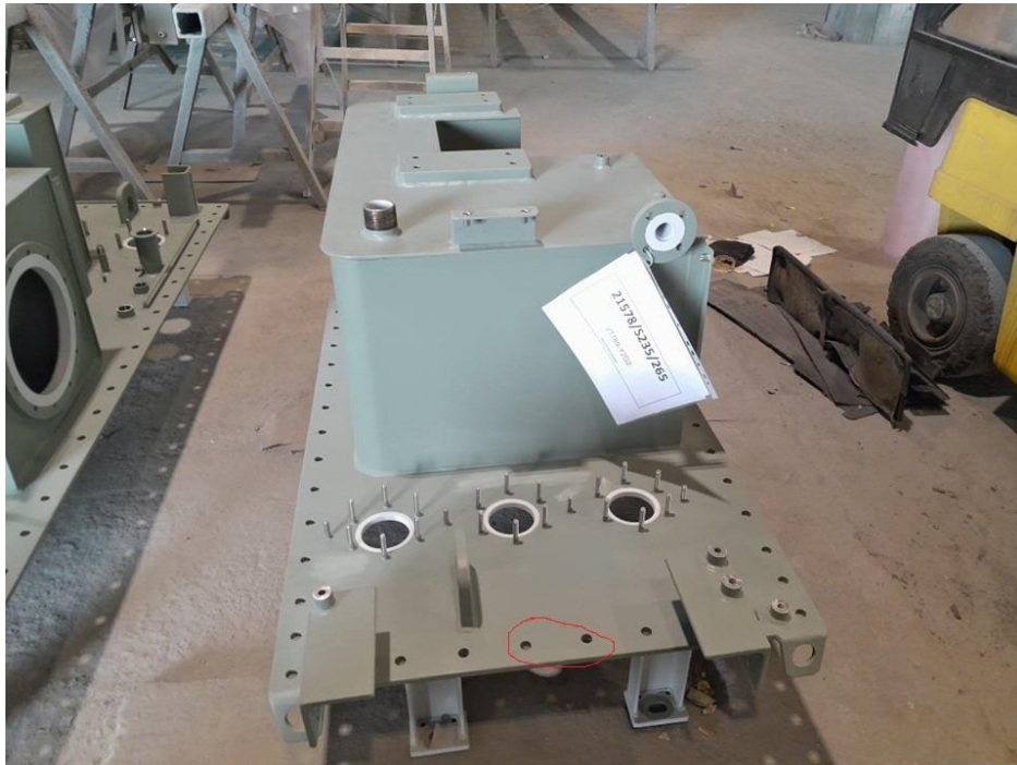
Slika 5.8 Nesukladnost na SBG Siemens poklopcu [19]
