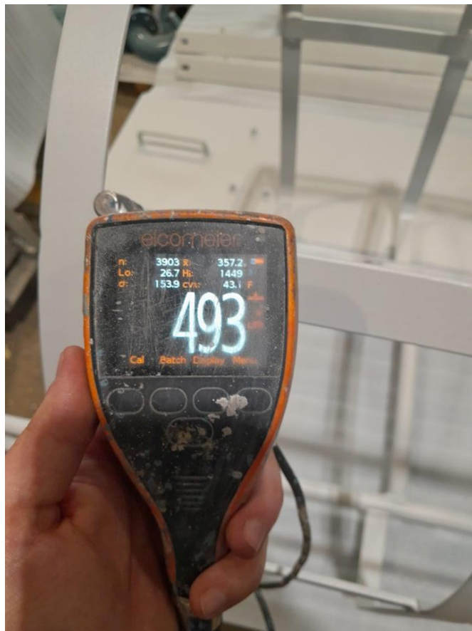
Slika 2.4. Kontrola nanosa antikorozivne zaštite [19]
