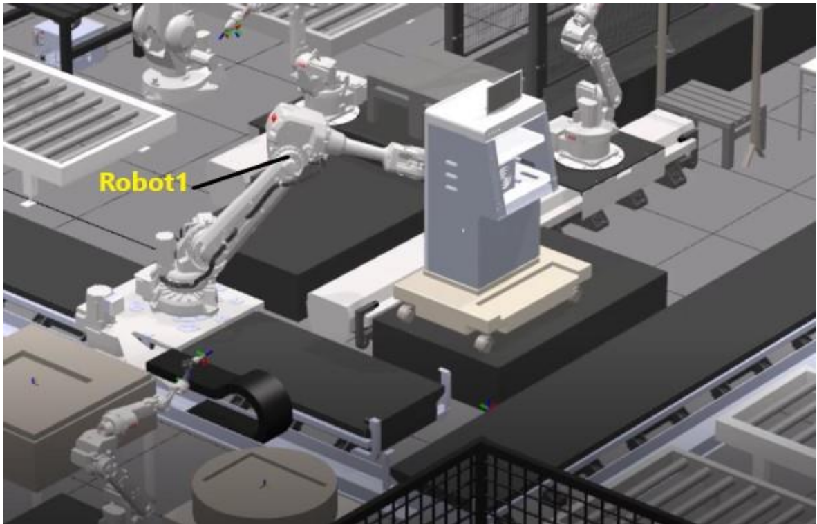
Slika 3.14. Robot1 postavlja stražnju ploču
