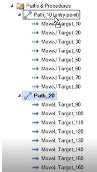
Slika 8.9. 'prebacivanje' putanje zavarivanja u glavnu putanju
