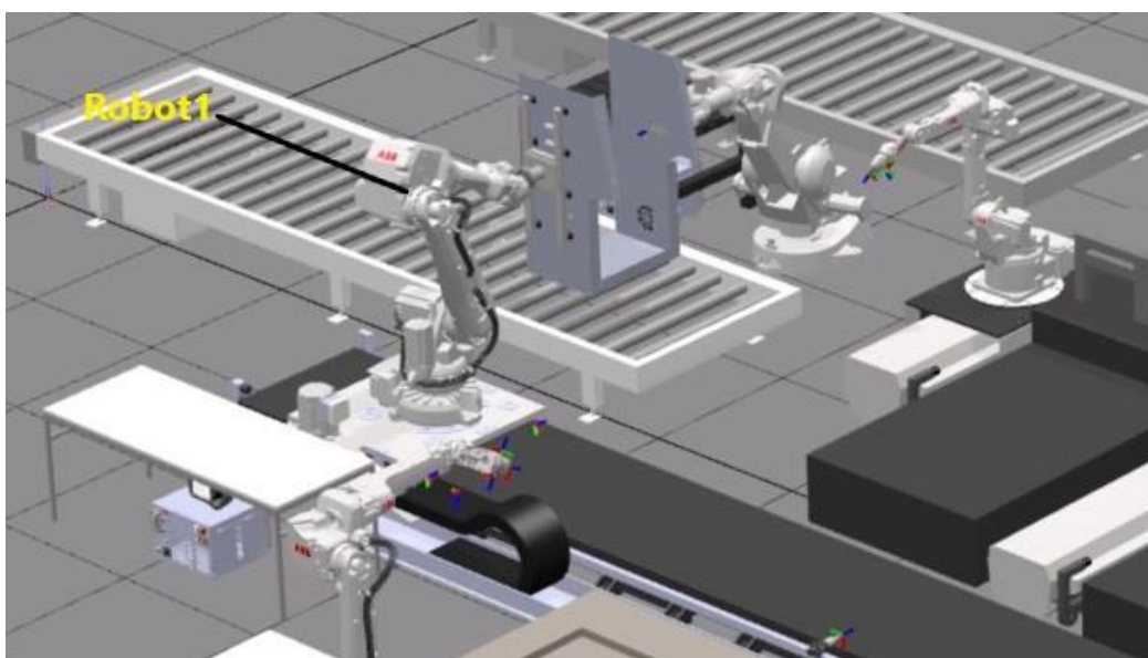
Slika 3.3. Robot1 preuzima tijelo dijalizatora
