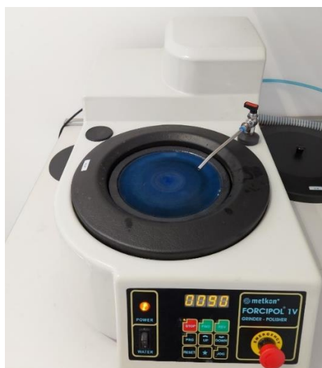
Slika 5.16 Brusilica Forcipol IV, marke Metkon
