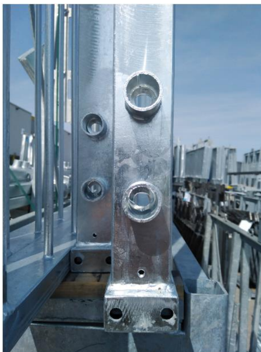
Slika 54: Zavareni "Segment" nakon cinčanja [11]
