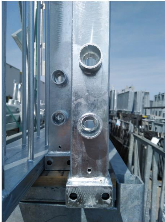
Slika 54: Zavareni "Segment" nakon cinčanja [11]
