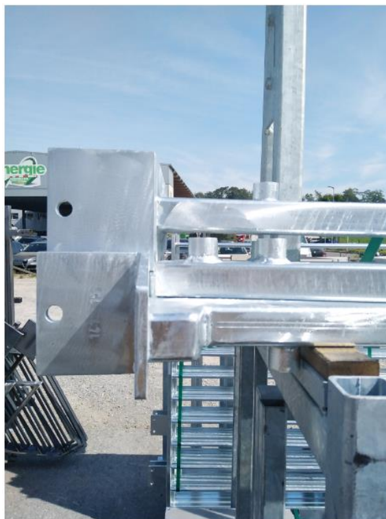
Slika 55: Zavareni stupovi nakon cinčanja [11]
