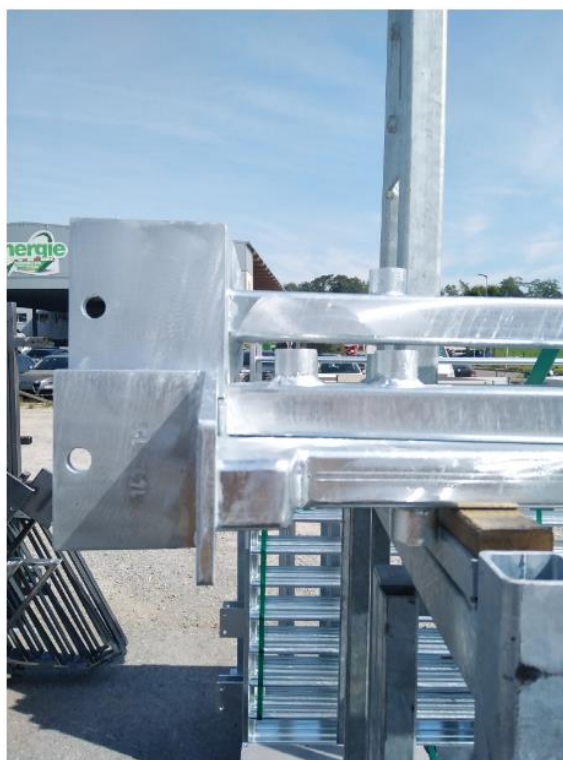
Slika 55: Zavareni stupovi nakon cinčanja [11]
