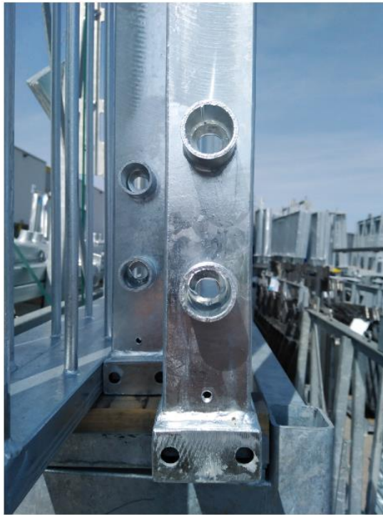
Slika 54: Zavareni "Segment" nakon cinčanja [11]
