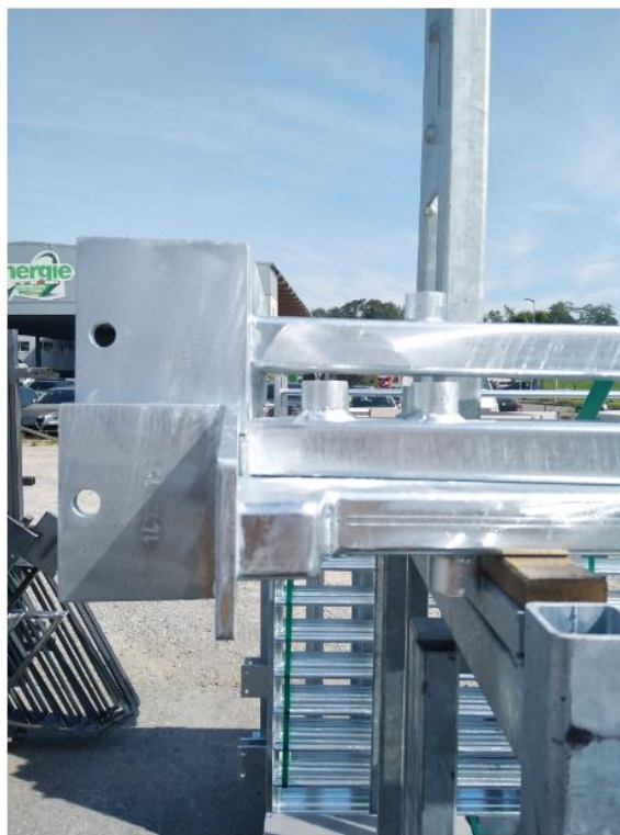
Slika 55: Zavareni stupovi nakon cinčanja [11]
