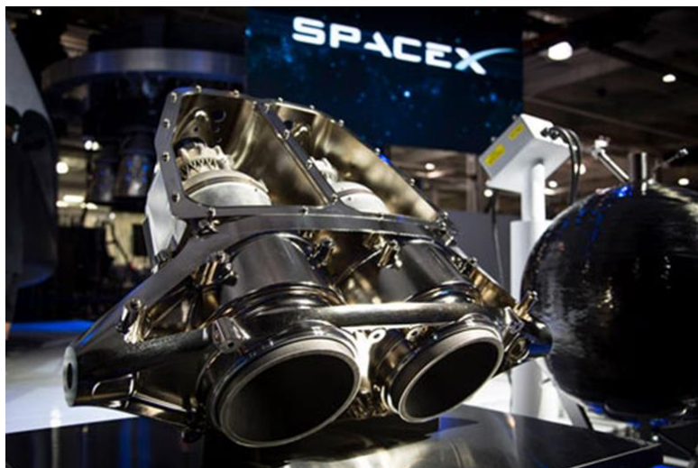
Slika 15. 3D tiskani "The SuperDraco" motor tvrtke SpaceX [22]
