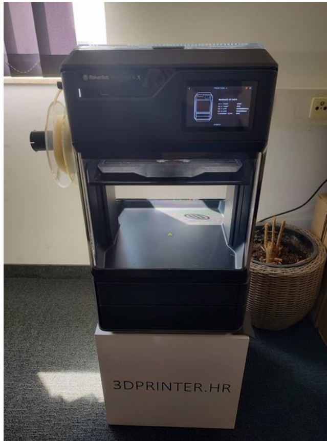
Slika 28. FDM uređaj korišteni za ispis PLA uzoraka
