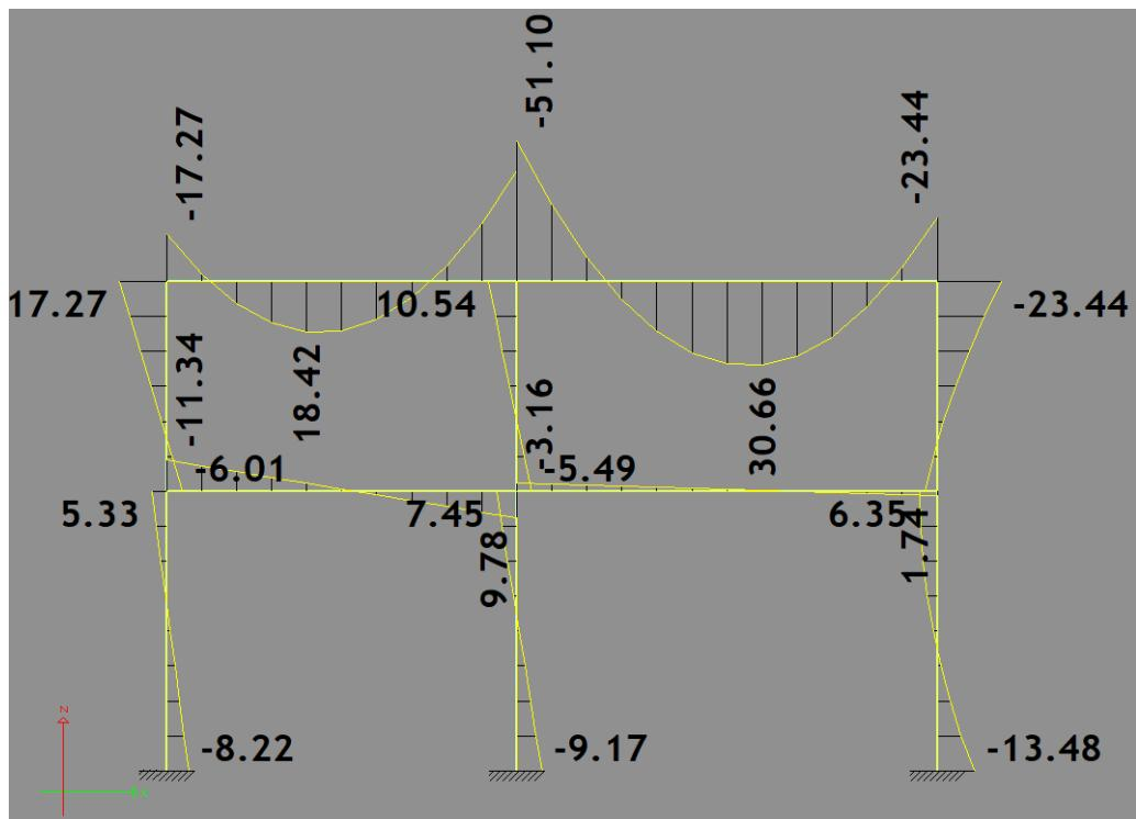
Slika 11. Grafički prikaz rezultata momenta savijanja oko y osi (M3) dobivenih u programu Tower – 3D Model Builder 8.4 DEMO
