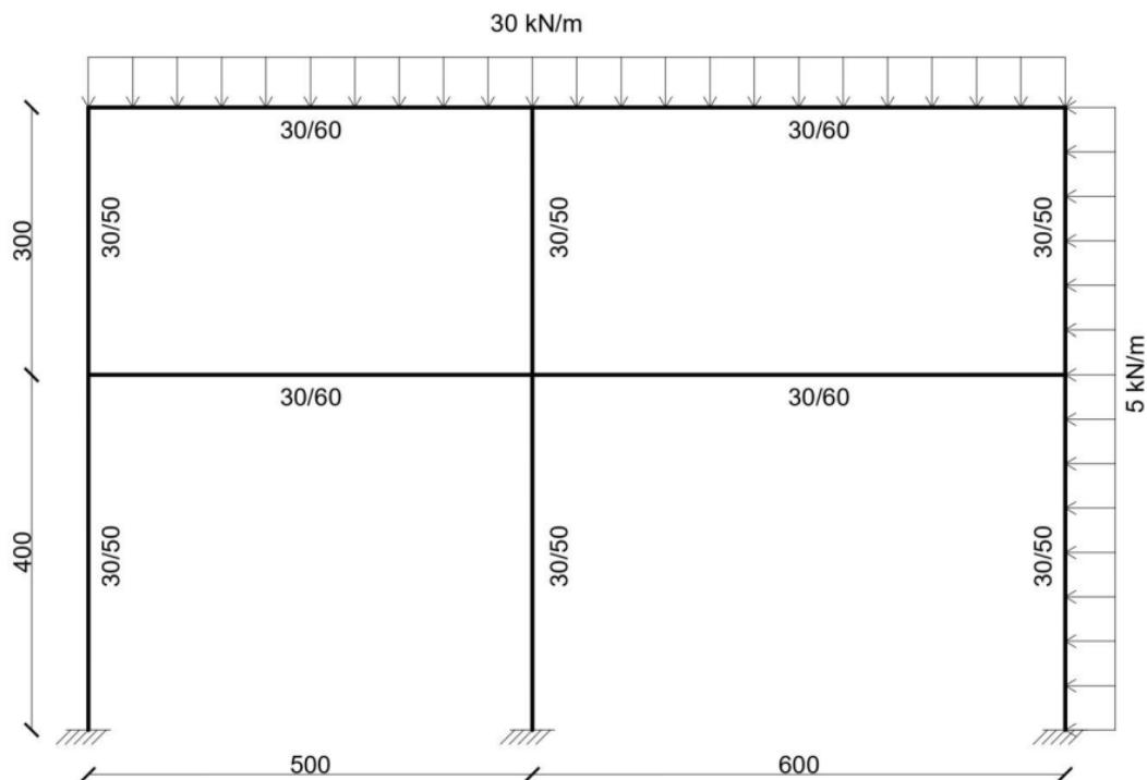
Slika 7. Primjer ravninskog okvira konstrukcije s zadanim opterećenjima korištenog u statickoj analizi
