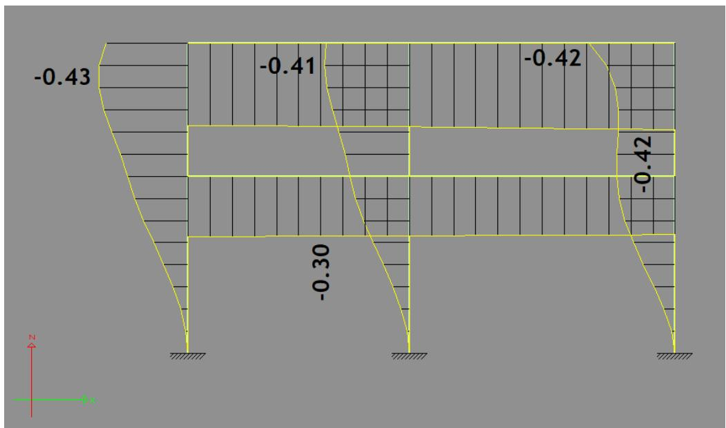
Slika 13. Grafički prikaz rezultata statičkih pomaka konstrukcije u x smjeru osi globalnog koordinatnog sustava dobivenih u programu Tower – 3D Model Builder 8.4 DEMO
