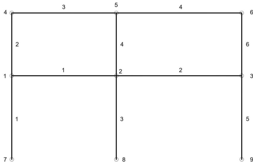
Slika 8. Shema ravninskog okvira konstrukcije s brojevima čvorova i konačnih elemenata (jedan konačni element za svaki konstrukcijski element)
