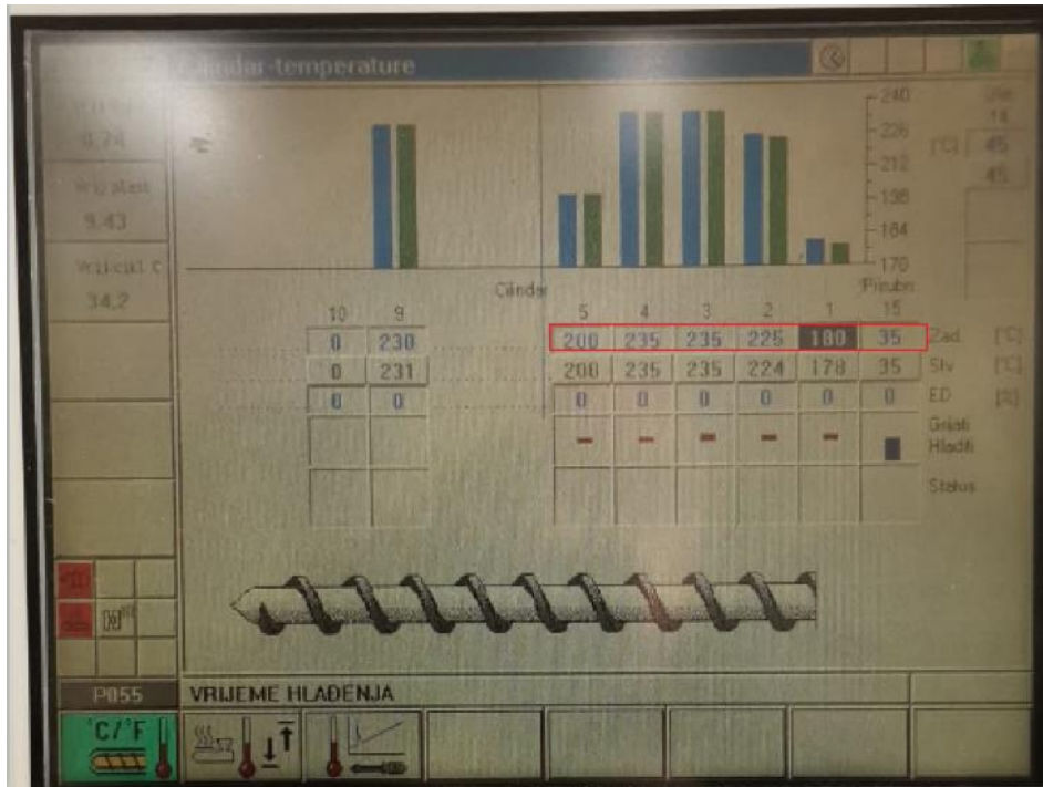
Slika 4.10.1. temperaturne zone cilindra ubrizgavalice [46]
