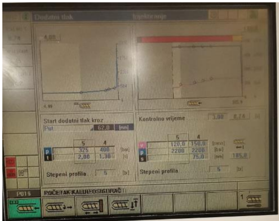
Slika 4.10.5. faza ubrizgavanja i djelovanja naknadnog tlaka [49]
