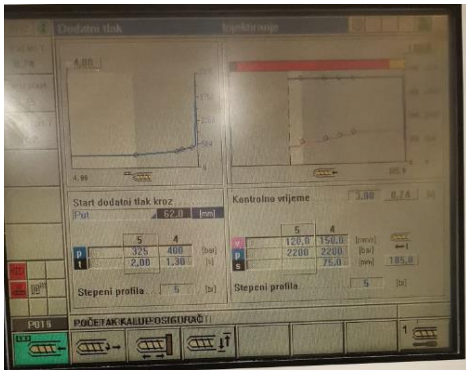
Slika 4.10.5. faza ubrizgavanja i djelovanja naknadnog tlaka [49]
