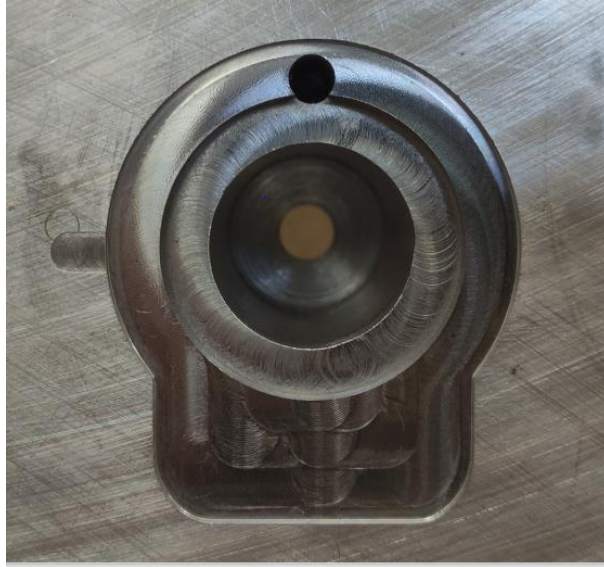
Slika 4.9.2.1.2. utor u koji se ugrađuje mlaznica [39]
