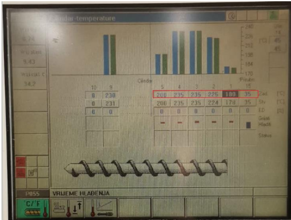
Slika 4.10.1. temperaturne zone cilindra ubrizgavalice [46]
