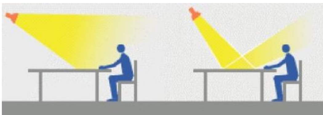
Slika 2.8 Direktno i indirektno bliještanje
