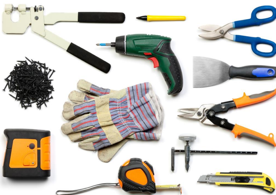
Slika 8. Osnovni alat i pribor za suhomontažnu gradnju [10]
