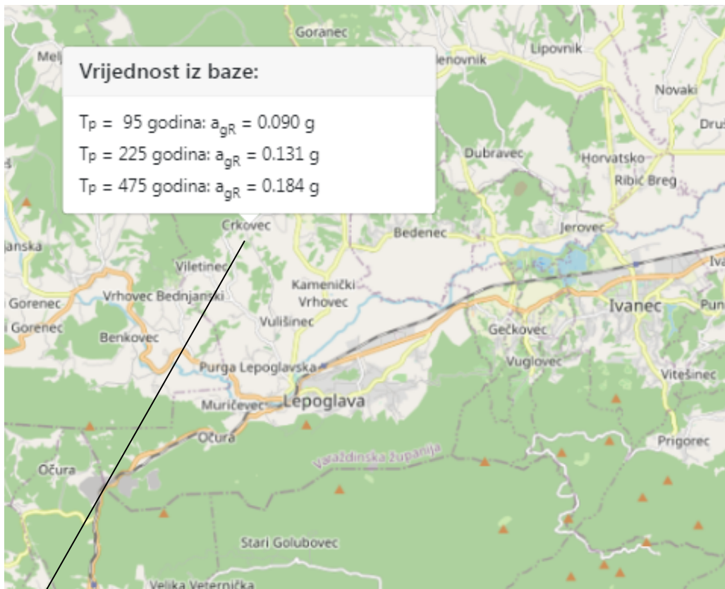
Slika 6.8. Parametar vršnog ubrzanja tla za promatranu lokaciju
