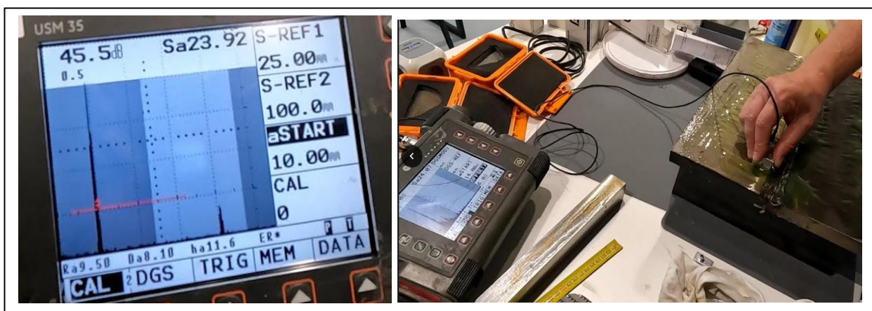
Slika 63. Baždarenje kutne sonde od 70° na ultrazvučni put na etalonu V2 (niskouglični čelik) i skeniranje zavara po materijalu S355J+N
