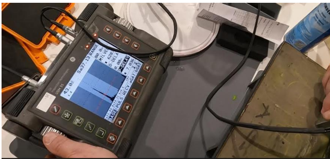
Slika 66. Skeniranje dvostrukom sondom
