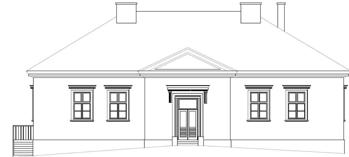
Slika 10. Planirano stanje - sjeverno pročelje [6]
