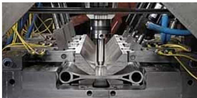
Slika 2.28 Zavarivanje trenjem rotirajućim alatom dijelova suspenzije vozila [47]
