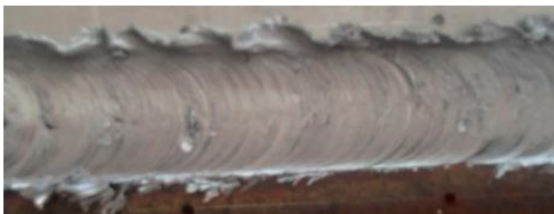
Slika 2.12 Prekomjerno istiskivanje i prekomjerno udubljenje lica zavara [22]
