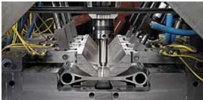
Slika 2.28 Zavarivanje trenjem rotirajućim alatom dijelova suspenzije vozila [47]
