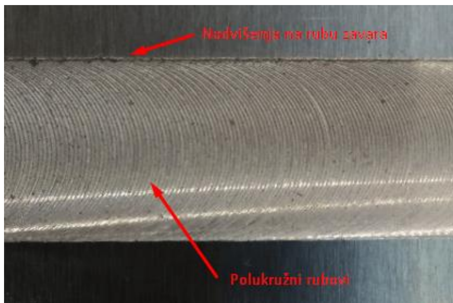
Slika 2.8 Izgled zavara nastalog zavarivanje trenjem rotirajućim alatom [15]
