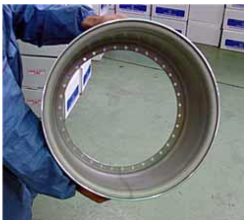
Slika 2.29 Zavarivanje trenjem rotirajućim alatom aluminijskih naplatka vozila [47]
