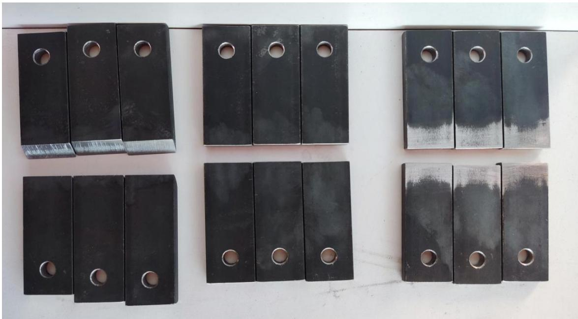
Slika 13 Pripremljeni materijal prije lijepljenja [autor Jurenec E., 17.10.2020.]
