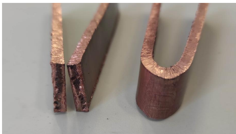
Slika 4.3.6 Savijanje lica zavora
