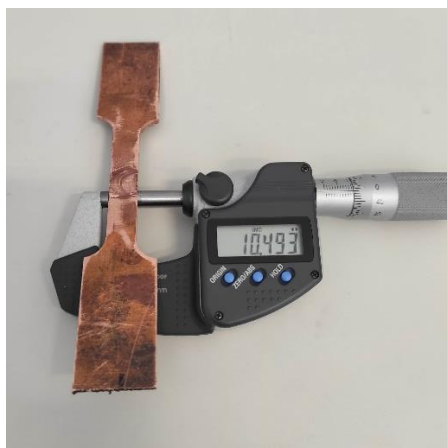
Slika 4.4.3 Širina paralelne dužine prve epruvete
