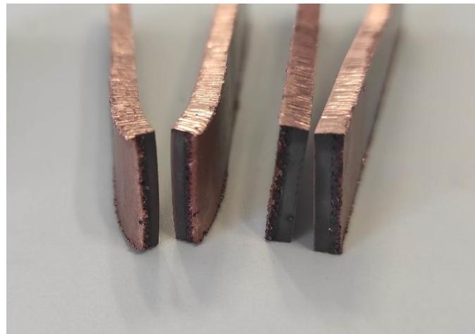
*Slika 4.3.2 Savijanje lica zavara*
