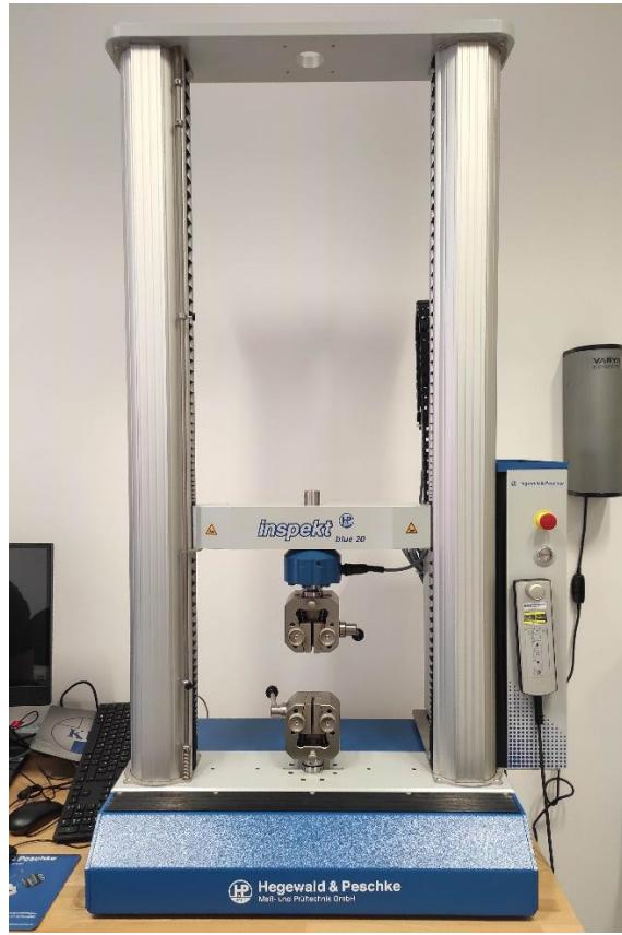
Slika 4.4.2 Kidalica za statičko vlačno ispitivanje
