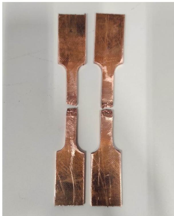
Slika 4.4.6 Epruvete nakon kidanja
