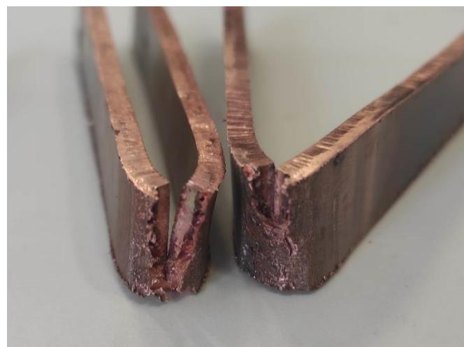
*Slika 4.3.6 Savijanje lica zavara*
