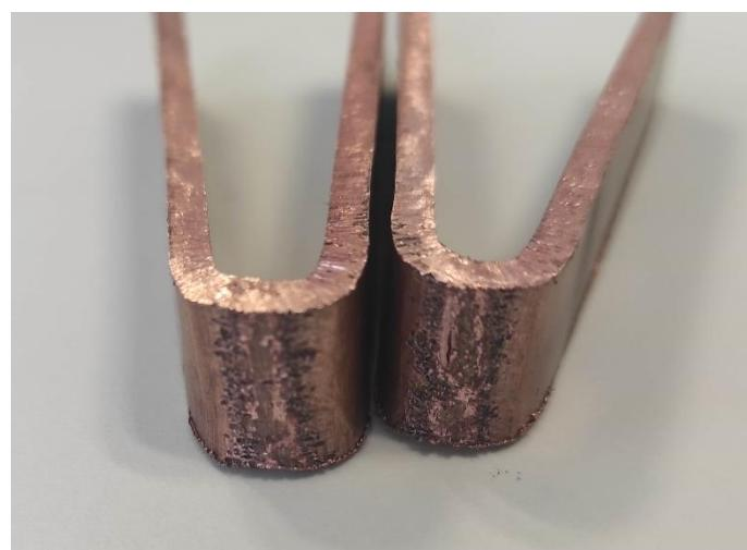
*Slika 4.3.4 Savijanje lica zavara*
