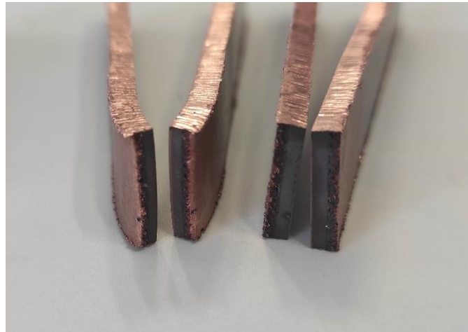
Slika 4.3.2 Savijanje lica zavara
