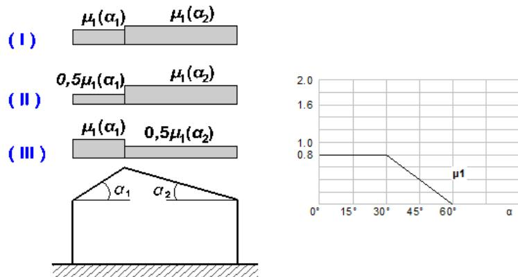
Slika 4.1. Opterećenje snijega na krov (EC1 EN1991-1-3:2003 §5)
