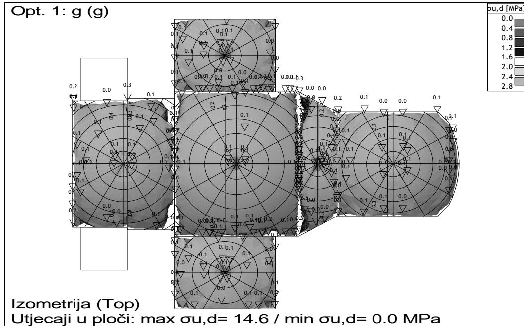
Slika 4.20. Prikaz naprezanja na glavne svodove (opt.1) - izometrija
