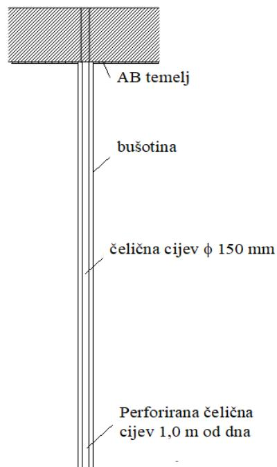
Slika 5.1. Skica pilota; temelj, bušotina, čelična cijev
