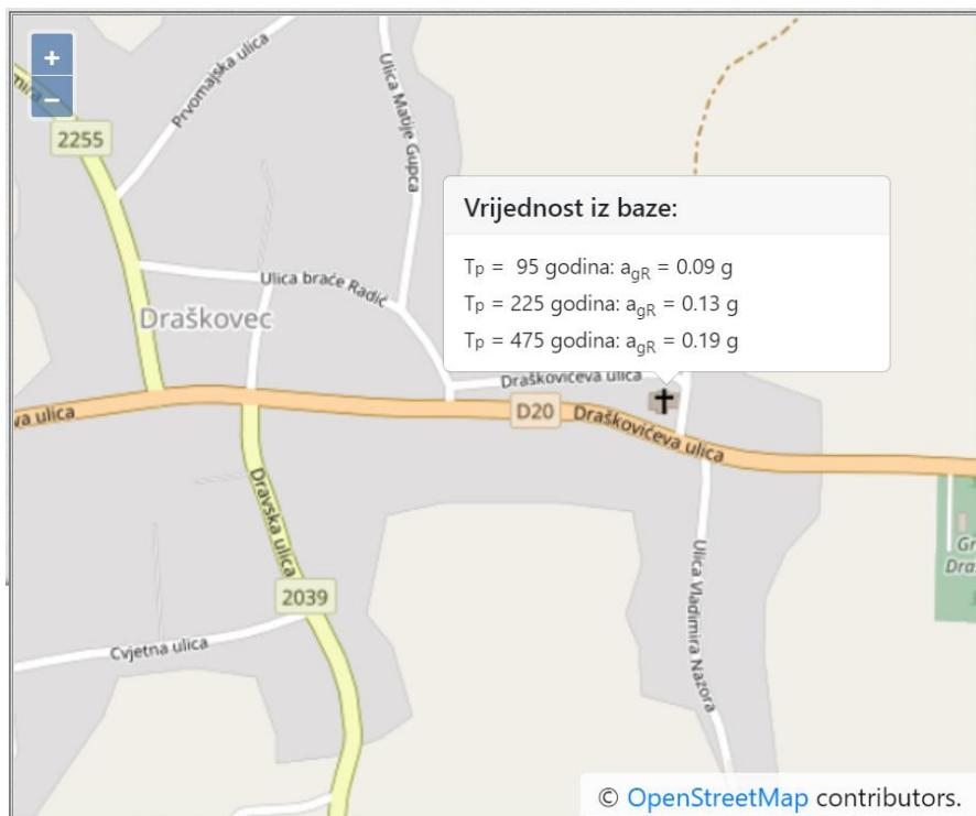
Slika 4.7. Iznosi horizontalnih vršnih ubrzanja tla tipa A ( $a_{gR}$ ) za povratna razdoblja od  $T_p = 95$  i  $475$  godina izraženih u jedinicama gravitacijskog ubrzanja ( $1 g = 9.81 \text{ m/s}^2$ ) – Izvor:
