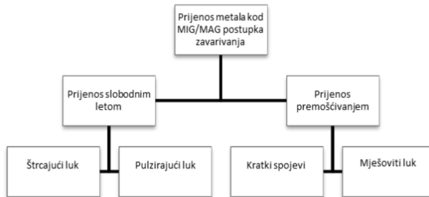
Slika 4.4 Mehanizam prijenosa metala kod MIG/MAG zavarivanja [11]
