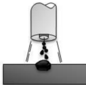
Slika 4.8 Prijenos metala mješovitim lukom [11]
