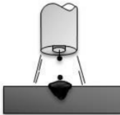
Slika 4.6 Prijenos metala pulsirajućim lukom [11]
