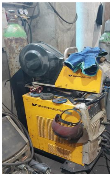
Slika 5.2 Daihen Varstroj Welbee P400 MIG
