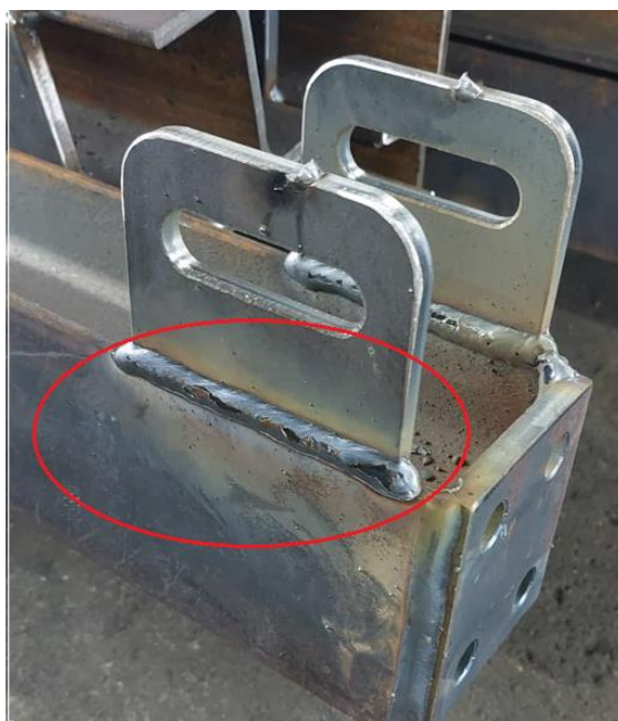
Slika 5.11 Prikaz pripreme žlijeba
