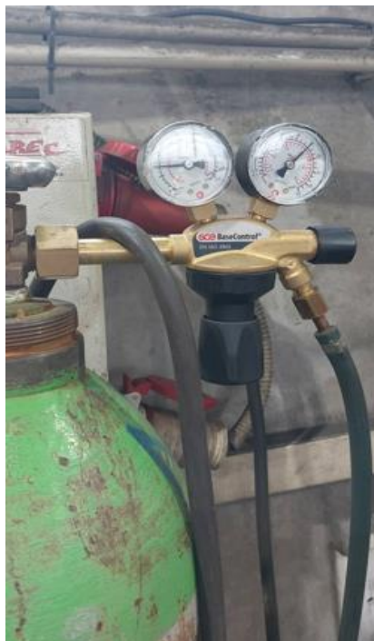
Slika 5.30 Prikaz brzine izlaska plina na manometru
