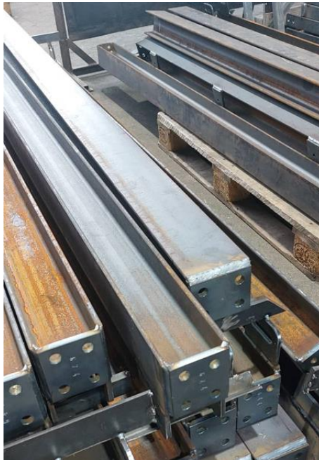
Slika 5.26 Stupovi spremni za daljnju obradu
