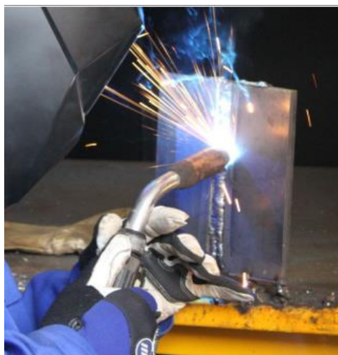
Slika 2.1 Spajanje metala zavarivanjem. [1]
