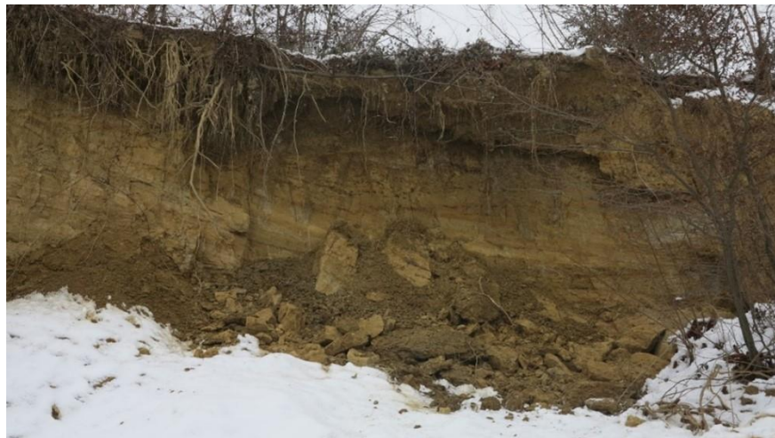
Slika 24: Denivelacija terena s pratećim odronima ocrta gornju konturu klizišta iznad B9 i B10[1]
