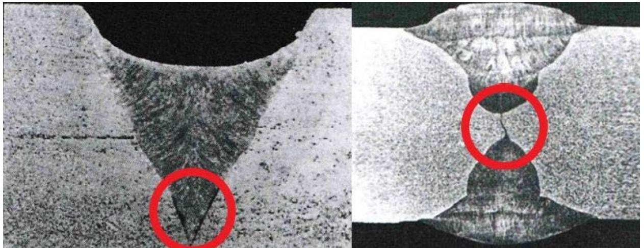
Slika 14. Naljepljivanje (lijevo) i nedovoljan provar (desno) [12]
