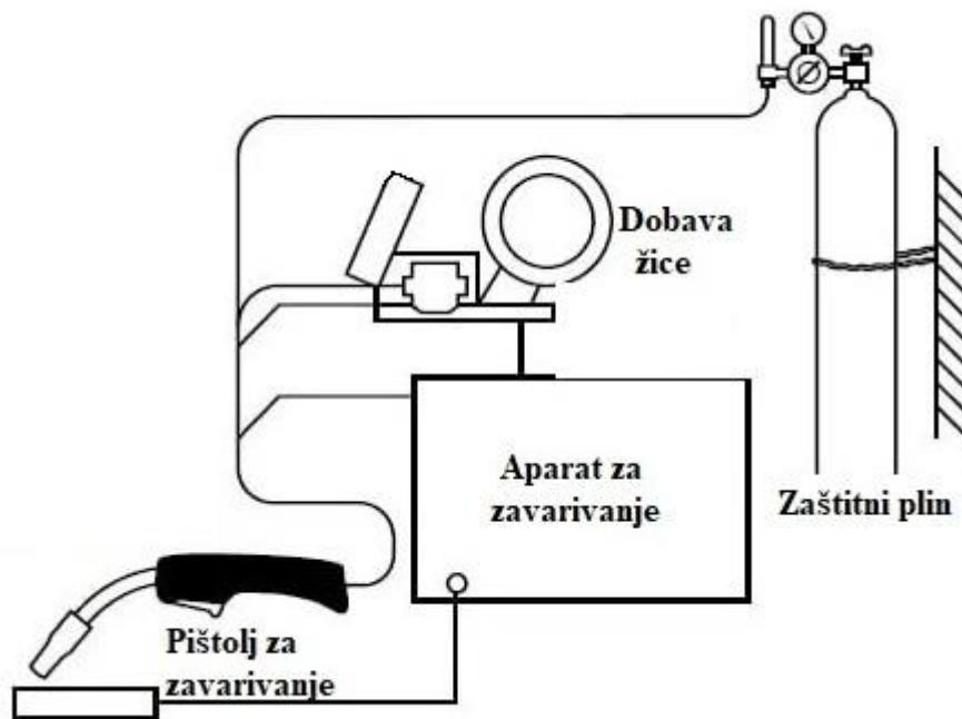
*Slika 5. Shematski prikaz opreme za MIG/MAG zavarivanje [9]*
