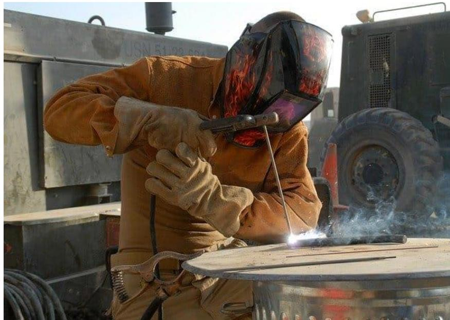
Slika 2. Zavarivanje REL postupkom [5]
