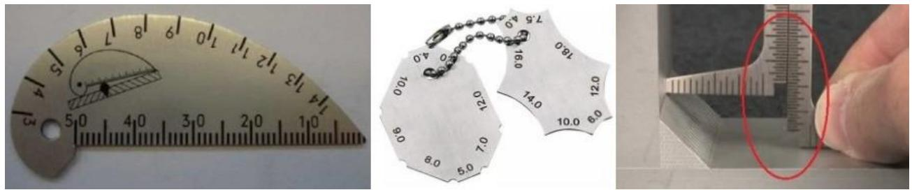
Slika 15. Mjerilo u obliku kapljice vode (lijevo), šablove za mjerjenje visine kutnog zavara (sredina), HI-LO mjerna skala (desno) [13]
