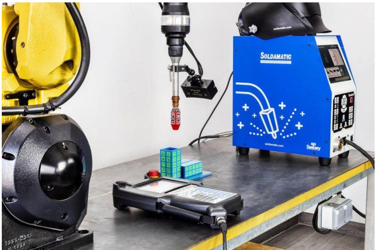
Slika 21. Programiranje robota pomoću Soldamatic simulatora za zavarivanje [24]
