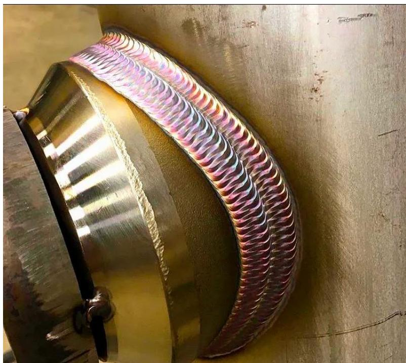
Slika 4. Izgled zavarenog spoja napravljen TIG postupkom [8]
