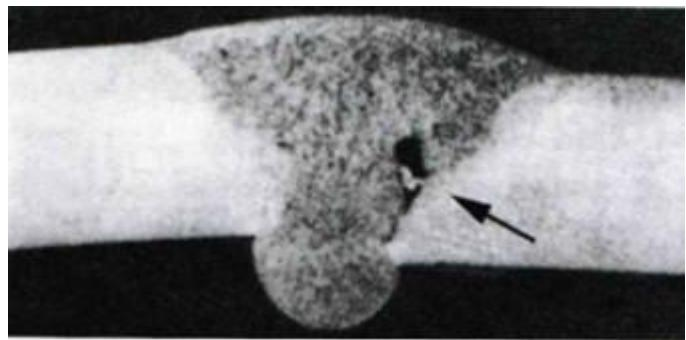
Slika 13. Čvrsti uključak u zavarenom spoju [12]
