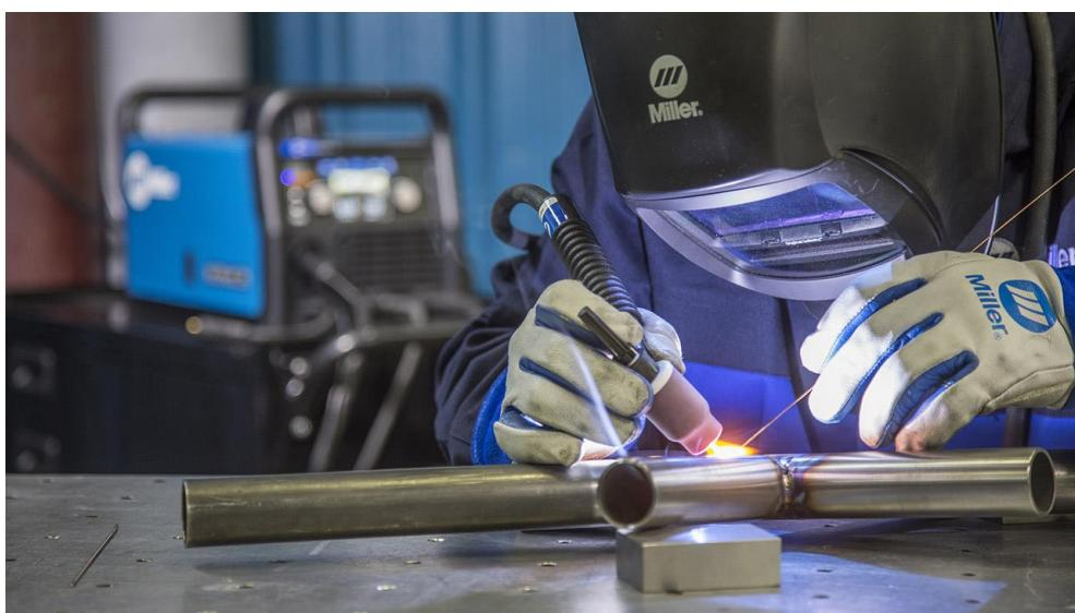
Slika 3. Zavarivanje TIG postupkom s dodavanjem dodatnog materijala [7]
