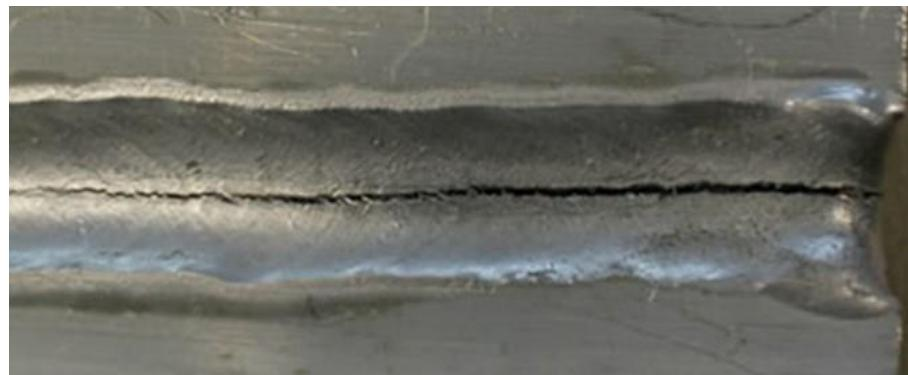
*Slika 12. Pukotina u zavarenom spoju [12]*
