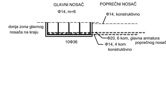
PRESJEK POPREČNOG NOSAČA, MJ 1:50
