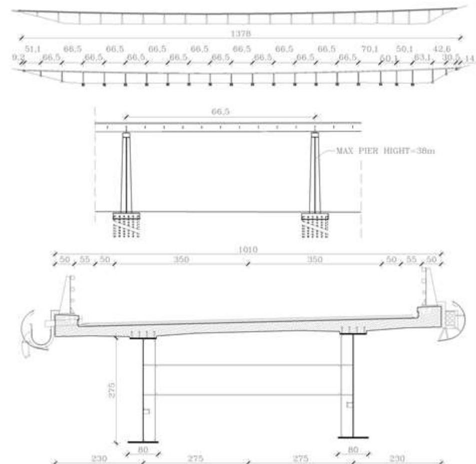
Slika 1.9. Shematski prikaz vijadukta preko rijeke Mirne
