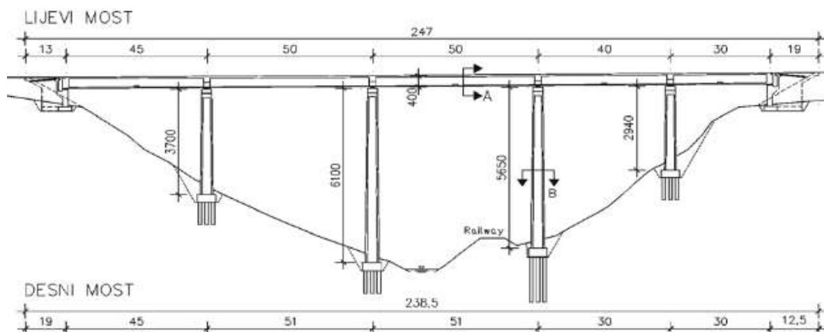
Slika 1.3. Uzdužni presjek vijadukta preko rijeke Dobre
