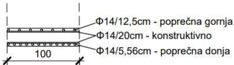
Slika 3.16. Raspored armature trećeg polja
