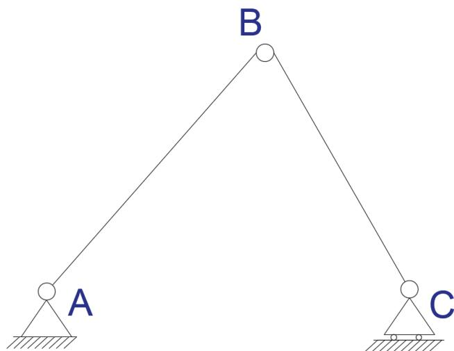
Slika 17 mehanizam s jednim stupnjem slobode kretanja
