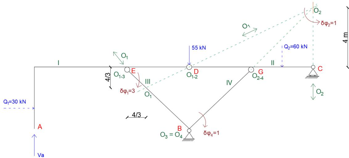
Slika 30 Određivanje rotacija ostalih diskova
