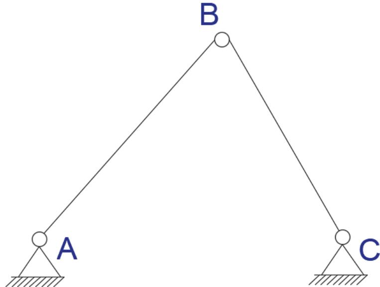
Slika 16 luk sa tri zgloba kinematički stabilan
