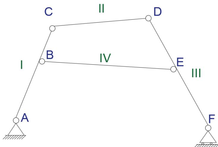
Slika 21 mehanizam s jednim stupnjem slobode kretanja.
