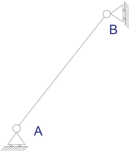
*Slika 11 Mehanizam s jednim stupnjem slobode kretanja*
