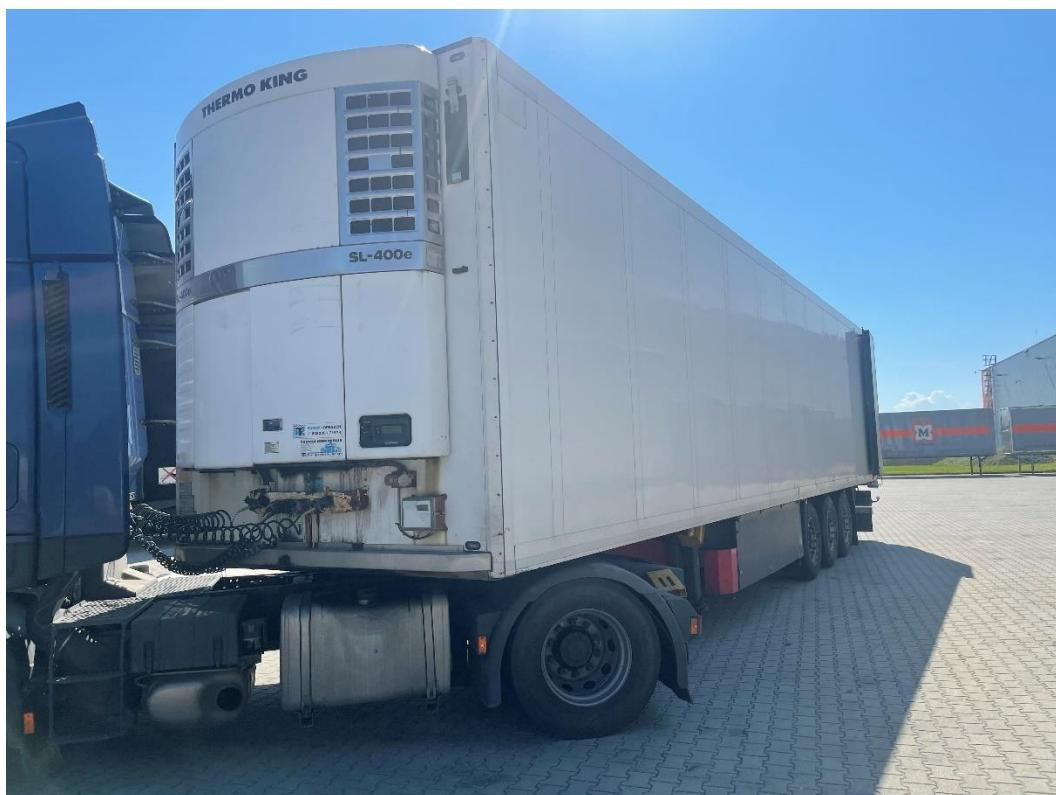
*Slika 29: Poluprikolica hladnjača sa ThermoKing rashladnim agregatom
