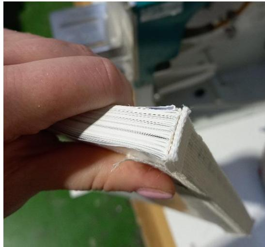
Gotove korice se lijepe na knjižni blok uz pomoć stroja. U stroj na stalak se stavi knjižni blok kojem po vanjskim stranicama prolaze valjci koji nanose lijepilo te se umeću korice, koje se čvrsto pritisnu kako bi se dobro sjedinili. Nakon lijepljenja korica, knjige je potrebno staviti pod prešu i ostaviti neko vrijeme da se lijepilo posuši, a kada su gotove, pregledavaju se te pakiraju za kupca.
