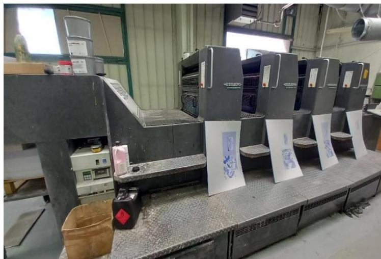
Papir se ručno ulaže na stol za papir i sam se poravnava, nagnje i prilagođava stroju, a bočne marke ga pozicioniraju pod određenim kutom tako da on može pravilno ući u stroj. Bočna marka na sebi ima oprugu, a ovisno o debljini papira ta opruga se mijenja. U ovom slučaju papir je deblji što znači da je potrebno staviti jaču oprugu koja će većom snagom vući i poravnavati papir u stroju.
