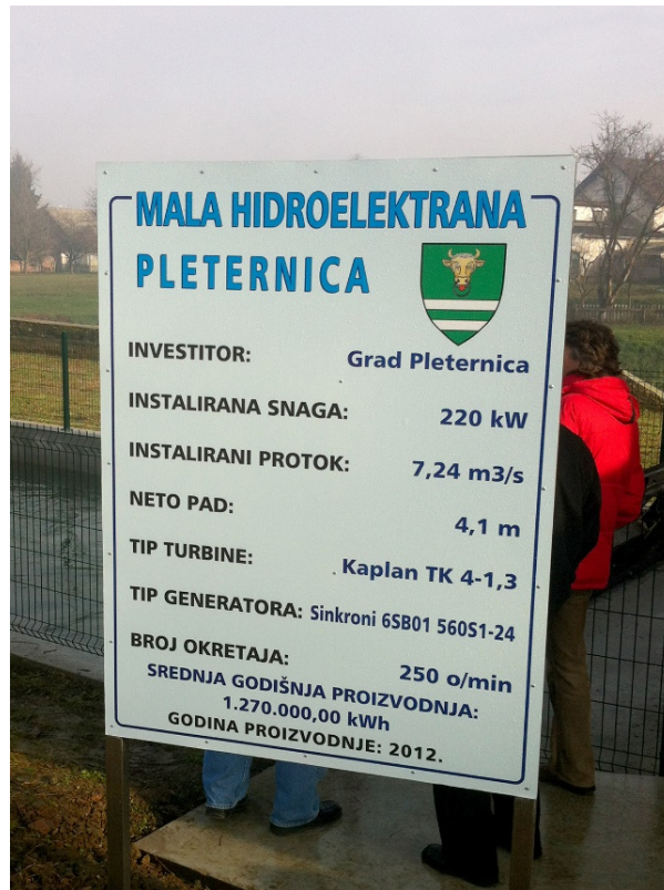
Slika 5 Tehnički podaci MHE Pleternica [5]
