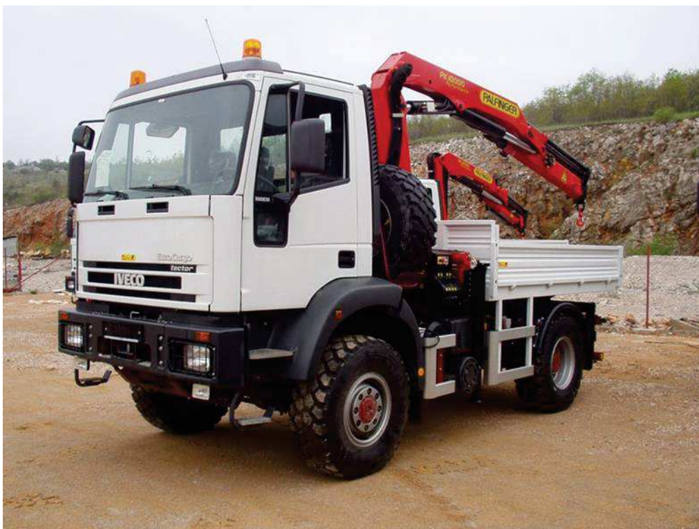
Slika 6. teretno vozilo s radnom nadogradnjom i tovarnim prostorom nosivosti do 12000 kg
