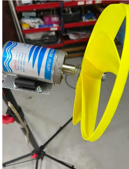
Slika 4.6. Montiranje prve verzije lopatica na osovinu generatora
