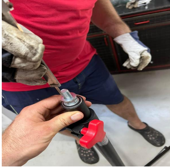
Slika 4.3. Sastavljanje mehanizma za okretanje postrojenja
