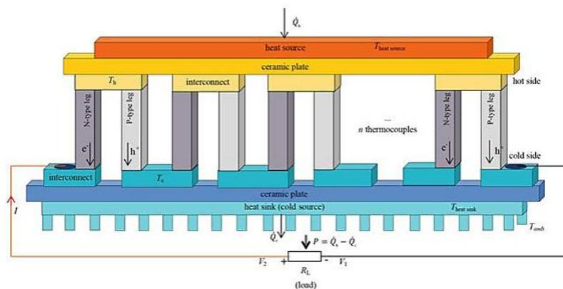
Slika 3.3 Termogenerator sastavljen od  $N$  termoparova [24]
