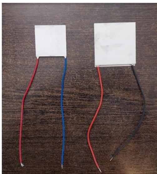
Slika 4.11 Termoelektrični moduli na kojima se izvode mjerenja
