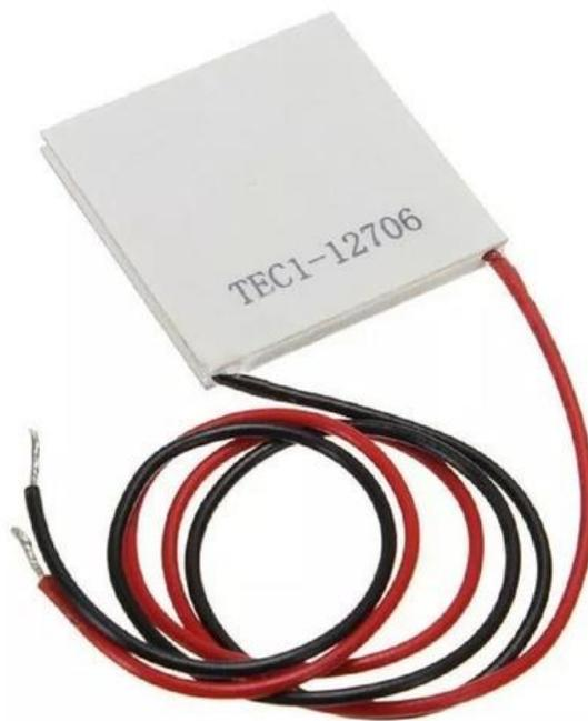
Slika 2.1 Termoelektrični modul (Peltierov element) [2]
