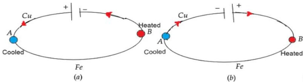
Slika 2.4 Ovisnost temperature spojeva o predznaku struje [7]
