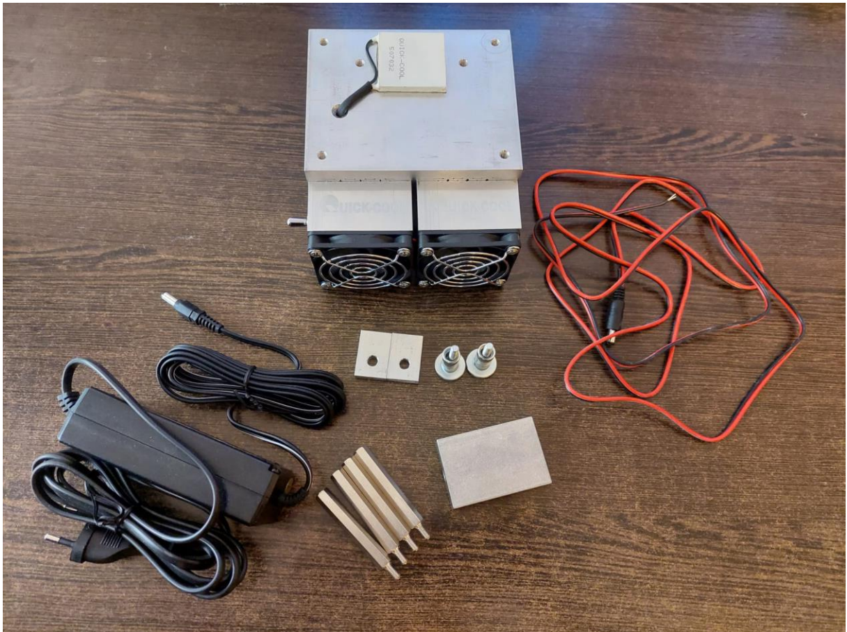
Slika 4.7 Sadržaj Peltier istraživačkog seta
