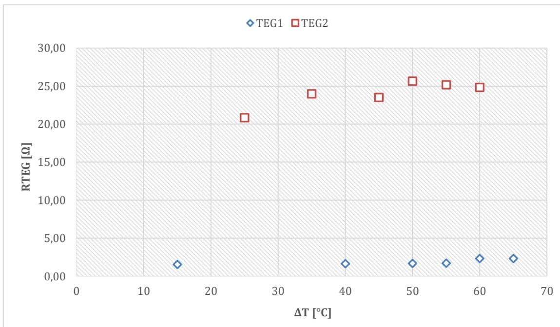
Slika 4.16 Unutarnji otpor termogeneratora TEG1 i TEG2
