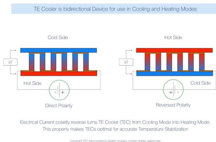
Slika 2.8 Termoelektrični hladnjak kao dvosmjerni uređaj [12]
