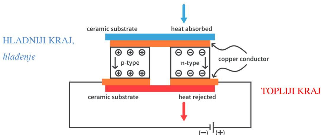
Slika 2.7 Princip rada termoelektričnog hladnjaka [11]
