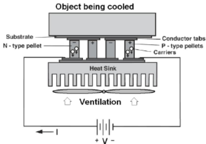
Slika 2.10 Izvedba Peltierove toplinske crpke i pasivnog hladnjaka [15]
