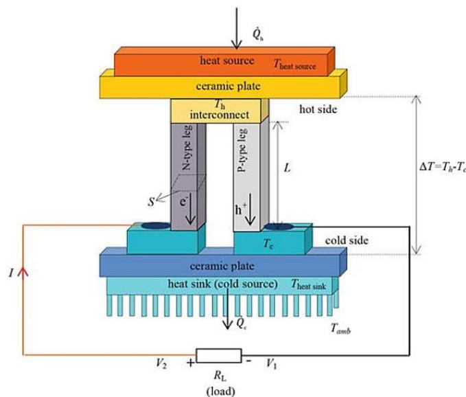
Slika 3.2 Osnovni sklop termogeneratora [24]
