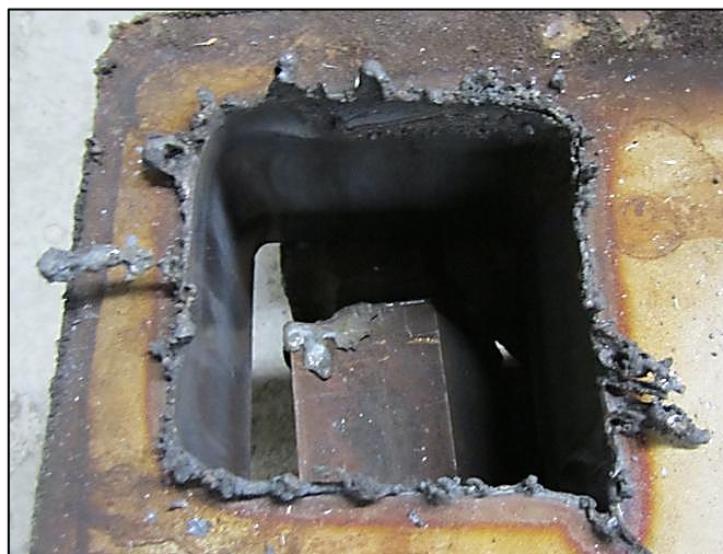
Slika 3.3.3. Nakupljena šljaka na površini ploče [15]
