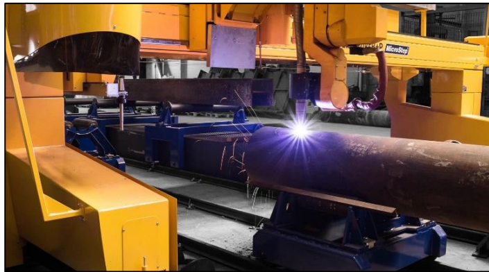
Slika 2.4.2. CNC plazma s rotirajućim plazma gorionikom [6]
