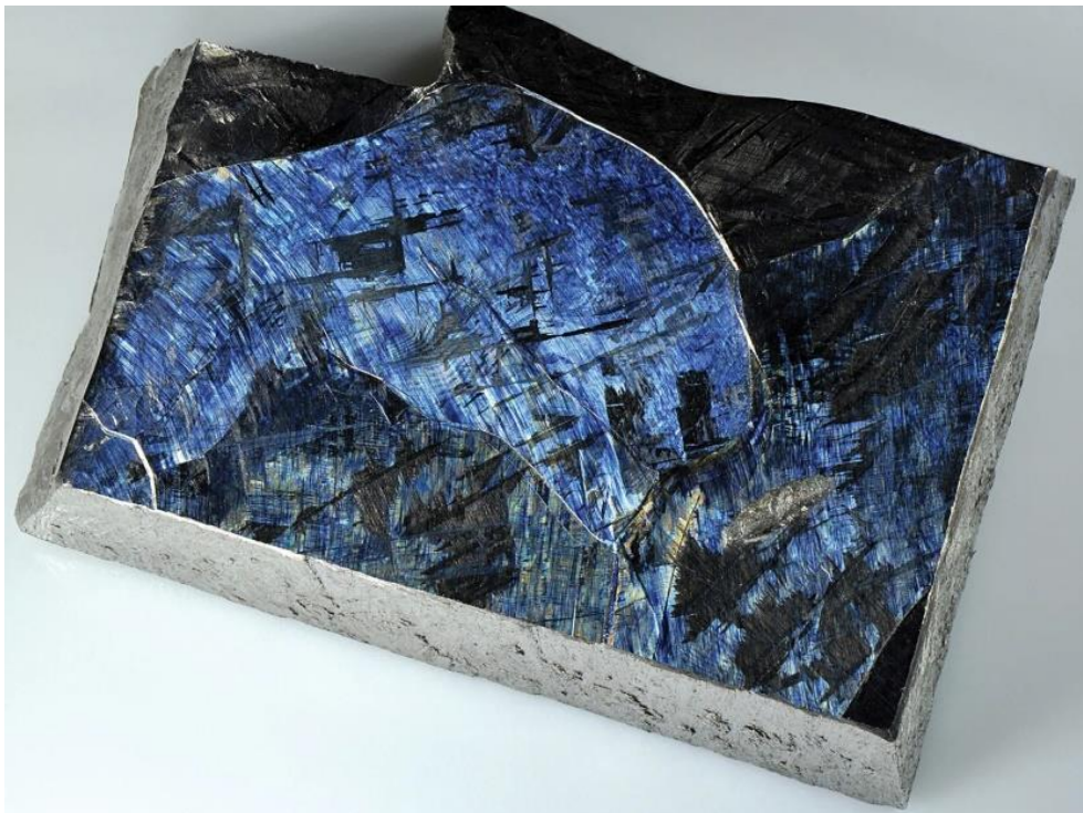
Slika 1. Metalni titan visoke čistoće 99,999% [3]
