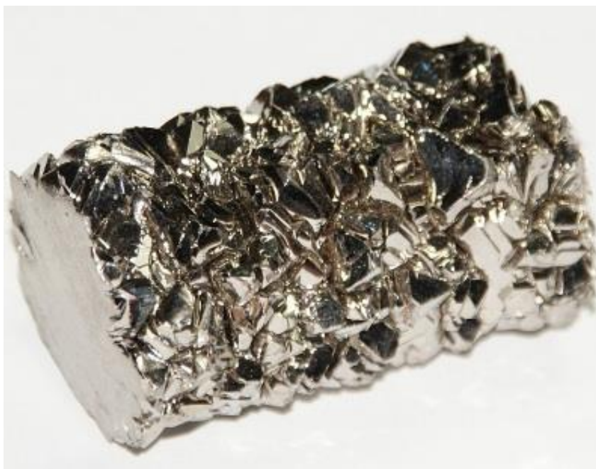
Slika 2. Kristal titana dobiven van Arkel – de Boer postupkom [2]
