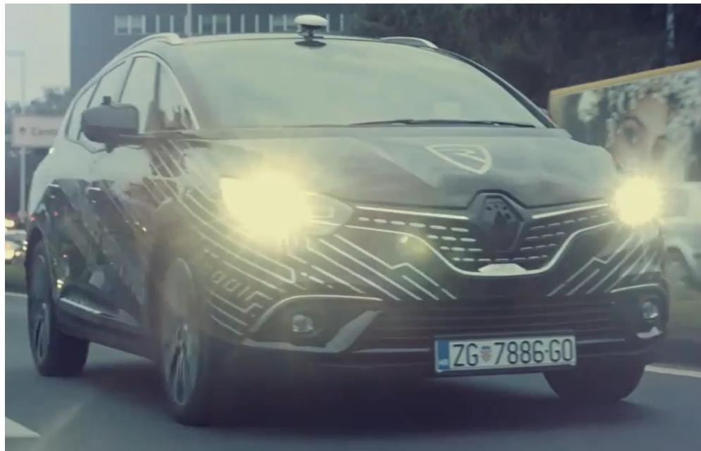
Slika 36. Testno autonomno vozilo tvrtke Rimac
