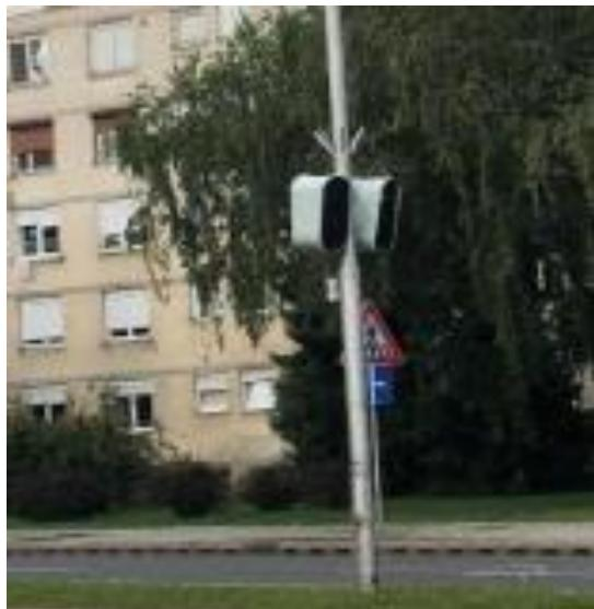
Slika 26. Kamere za nadzor brzine
