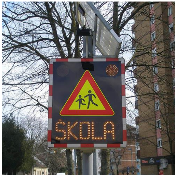
Slika 28. Promjenjiva prometna signalizacija opremljena senzorima Izvor: Autorica
