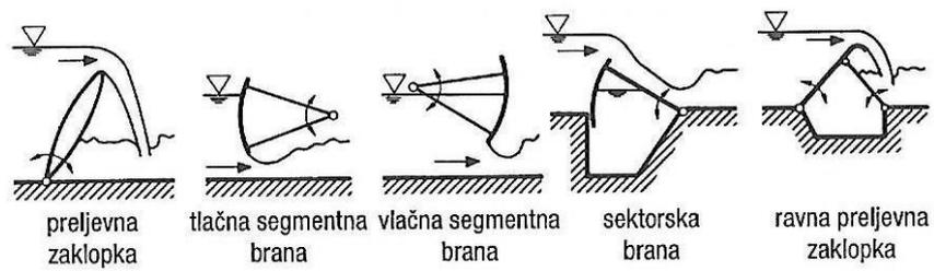
Slika 2.11. Shema nekoliko izvedbi pomičnih brana za MHE [4]
