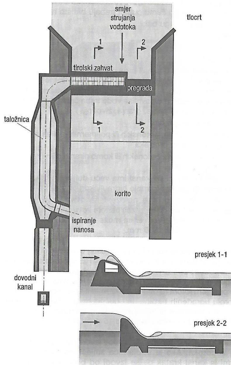
Slika 2.15. Shema tirolskog zahvata – Tlocrt, Presjek 1-1 i Presjek 2-2 [4]
