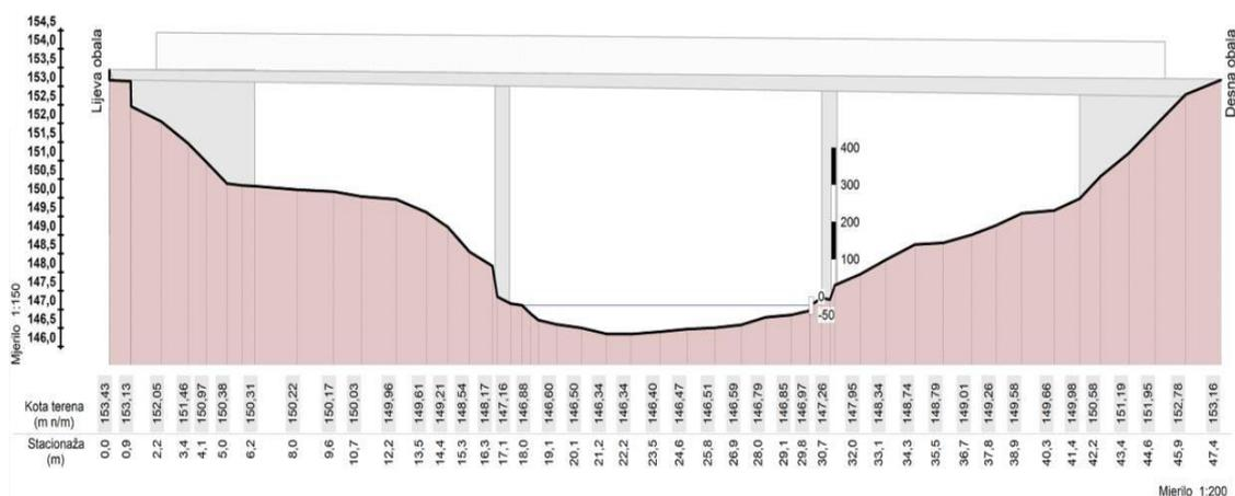
Slika 5.9. Karakteristični poprečni presjek korita Ludbreg - Bednja [34]
