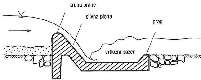
Slika 2.10. Shema čvrste brane za male hidroelektrane [4]
