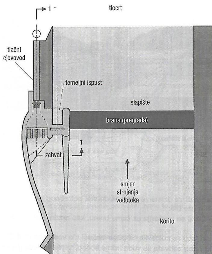
Slika 2.13. Shema bočnog zahvata – Tlocrt [4]
