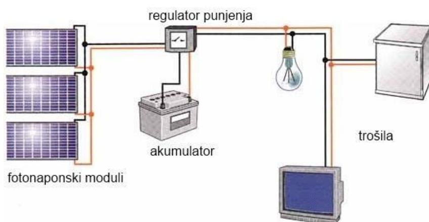
Slika 3.3. Glavni komponenti samostalnog fotonaponskog sustava [22]
