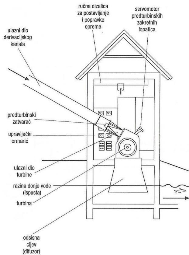
Slika 2.7. Shema strojarnice derivacijske MHE [4]
