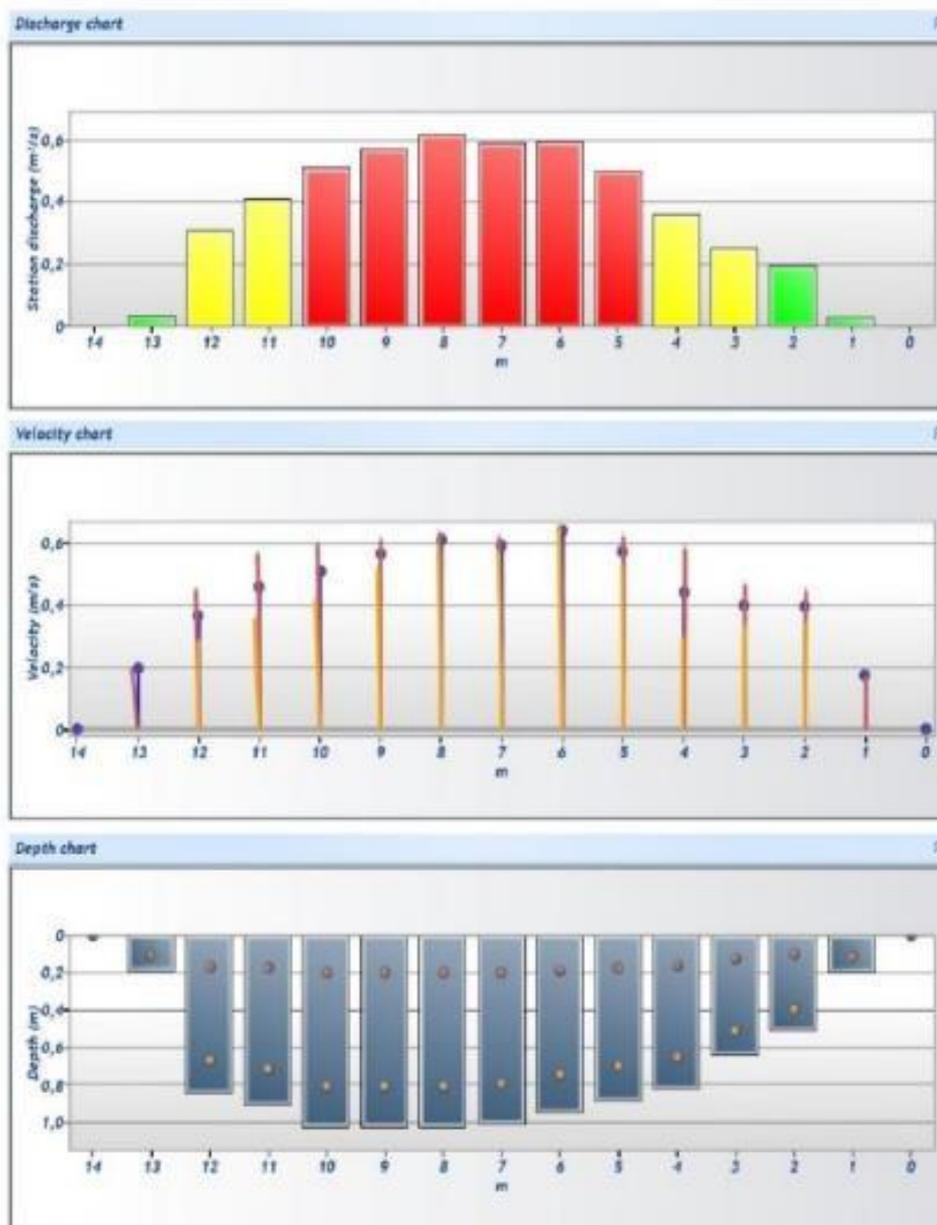
Slika 6.10. Grafički prikazi rezultata prebačenog mjerenja u Ludbregu – prikaz protoka, brzina i dubina na svakoj mjernoj stanici
