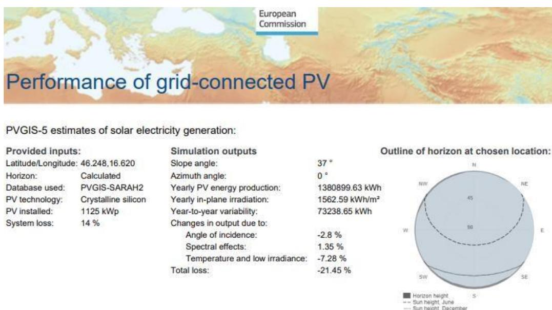
Slika 6.17. Odabrani ulazni parametri za izračun snage solarne elektrane na rijeci Bednji korištenjem programa Photovoltaic Geographical Information System [33]
