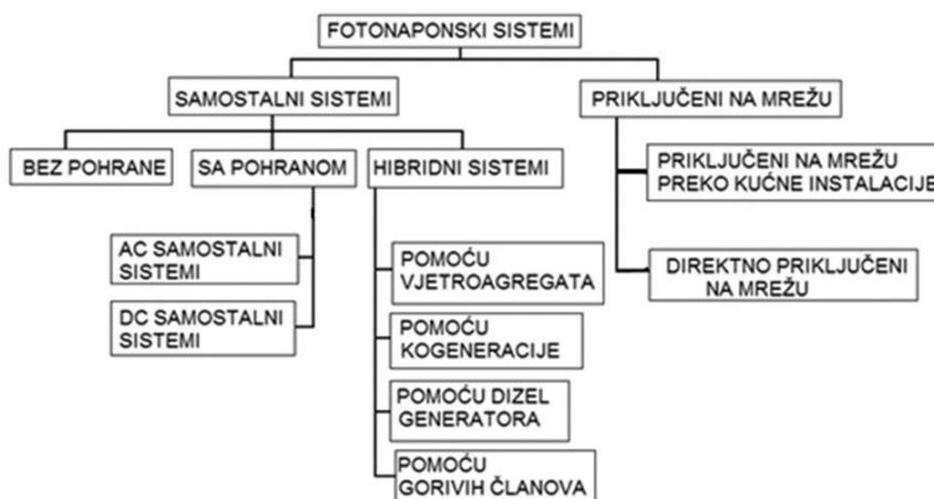
Slika 3.2. Osnovna podjela fotonaponskih sustava [20]
