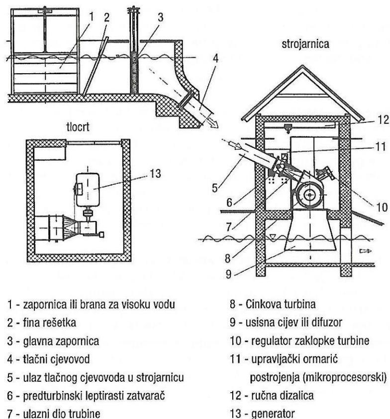
Slika 2.2. Shema srednjotlačne odnosno visokotlačne male hidroelektrane [4]
