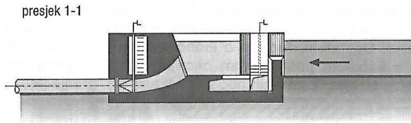
Slika 2.14. Sheme bočnog zahvata – Presjek 1-1 [4]
