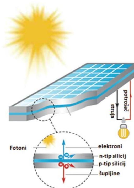
Slika 3.1. Fotonaponski efekt [20]
