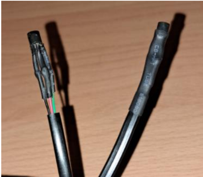
Slika 3.22. Prikaz senzora bez dodatnog bužira (lijevo) i vodootporni senzor sa duplim bužinom (desno)
