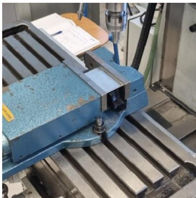
Slika 24. Pločice postavljene u škrip, prije procesa zavarivanja
