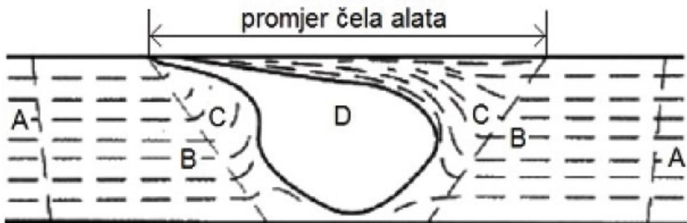
Slika 19. Skica poprečnog presjeka zavara dobivenog FSW postupkom zavarivanja:
