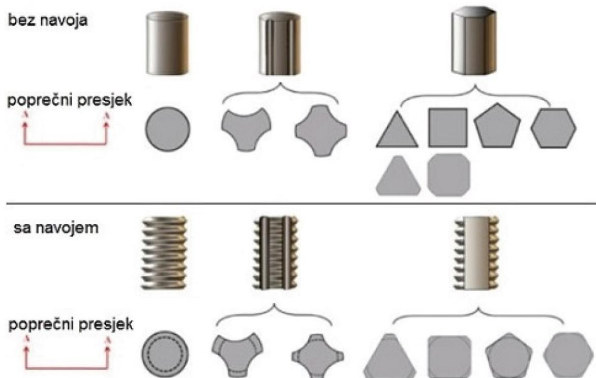
Slika 16. Oblik cilindričnih trnova alata, sa i bez navoja na bočnom dijelu [13]
