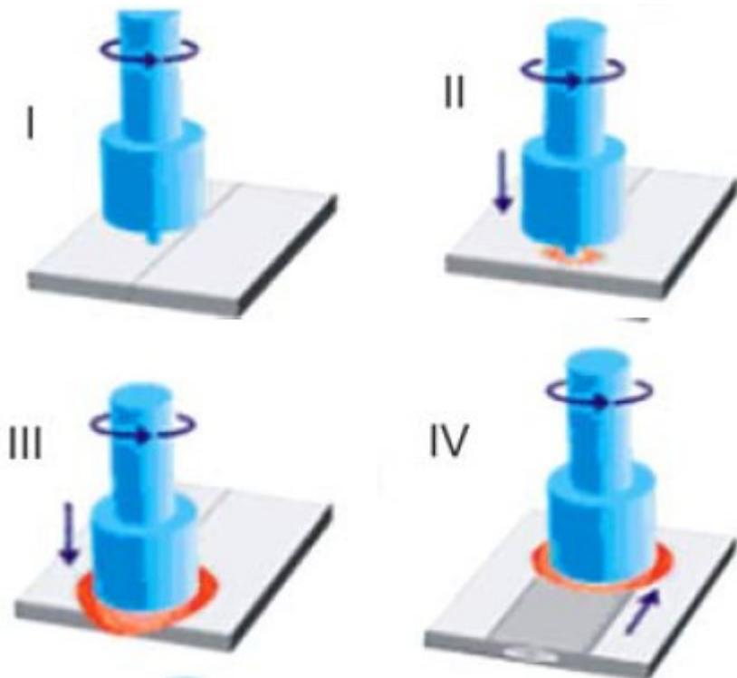
Slika 3. Faze procesa zavarivanja FSW postupkom [5]
