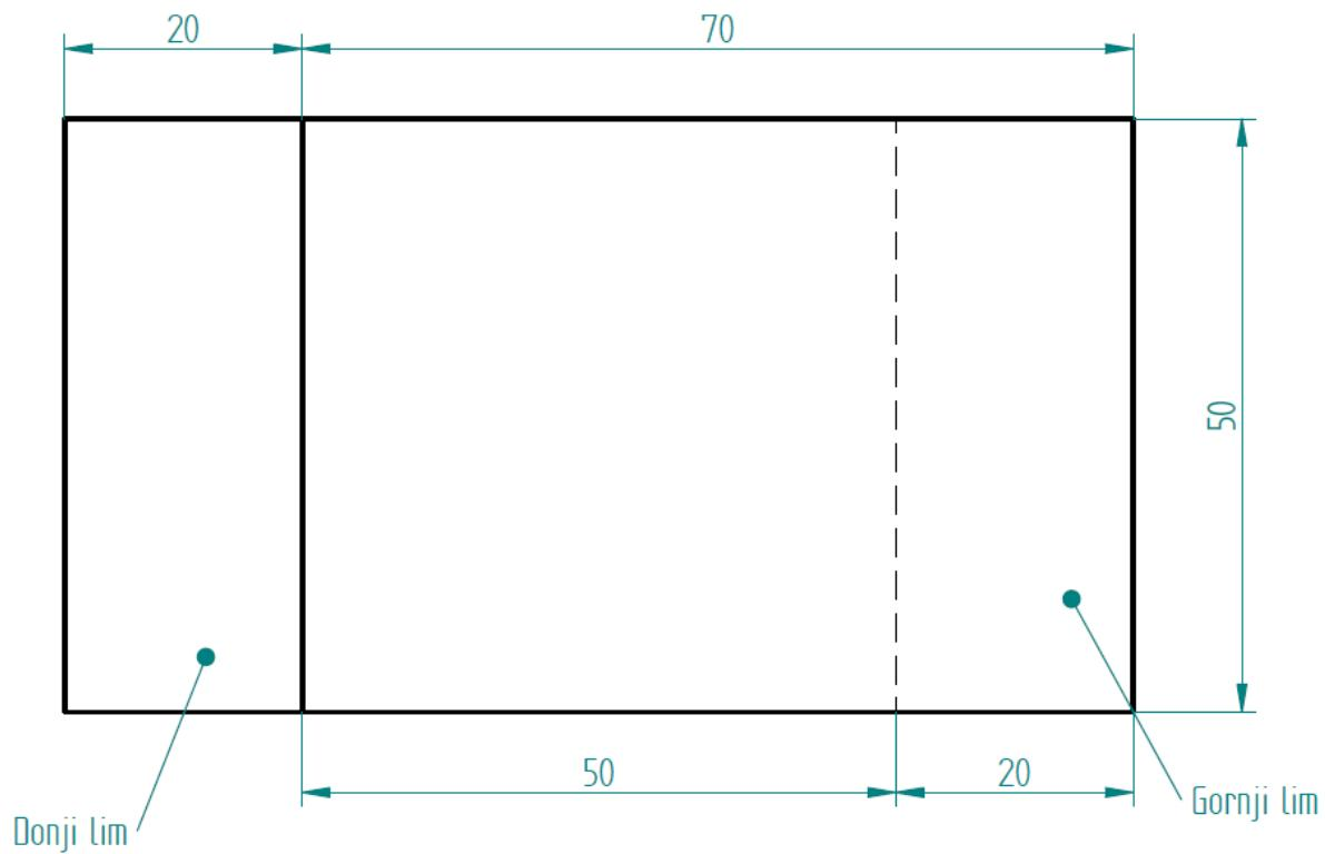
Slika 20. Preklop limova prilikom zavarivanja
