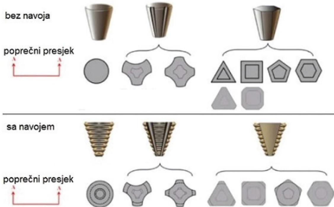
Slika 17. Oblik konusnih trnova alata, sa i bez navoja na bočnom dijelu [13]
