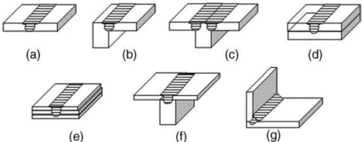
Slika 7. Oblikovanje spojeva za FSW postupak zavarivanja:
