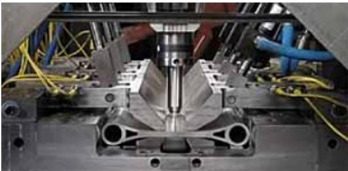
Slika 12. Primjena FSW postupka u automobilskoj industriji [8]
