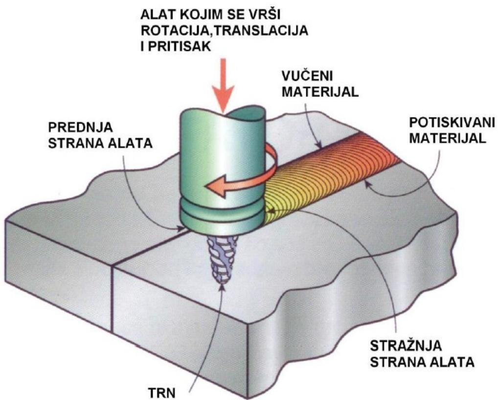
Slika 2. Shema zavarivanja FSW postupkom [4]
