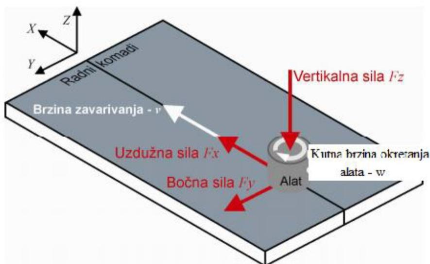
Slika 6. Prikaz sila koje su prisutne prilikom FSW postupka zavarivanja [9]
