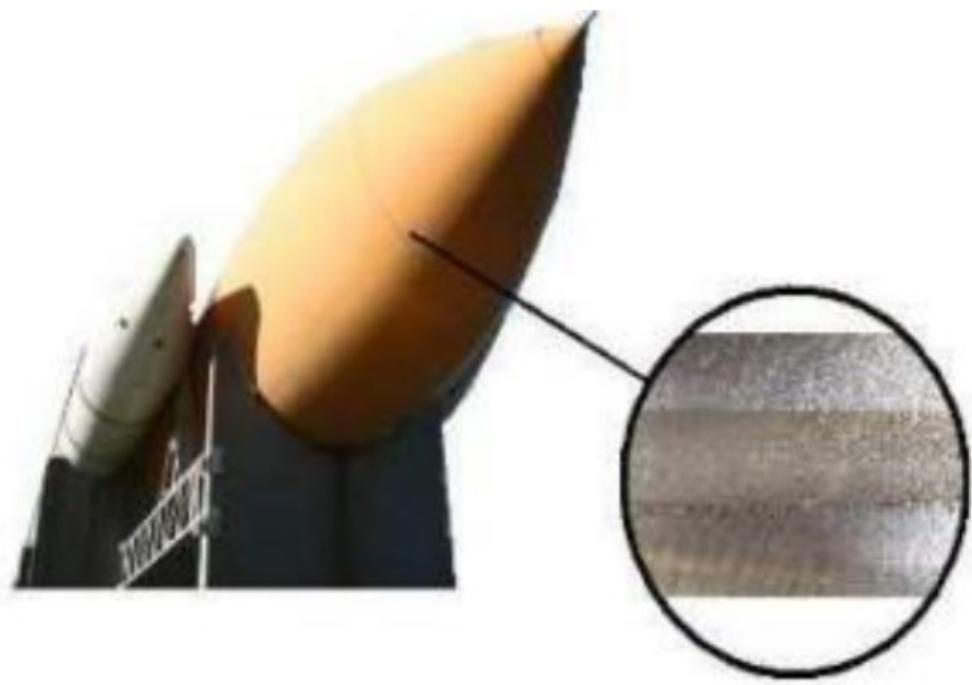
Slika 10. Spremnik goriva svemirske rakete zavaren FSW postupkom [9]
