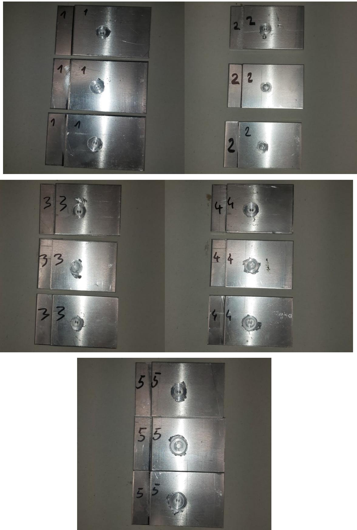
Slika 26. Zavarene pločice
