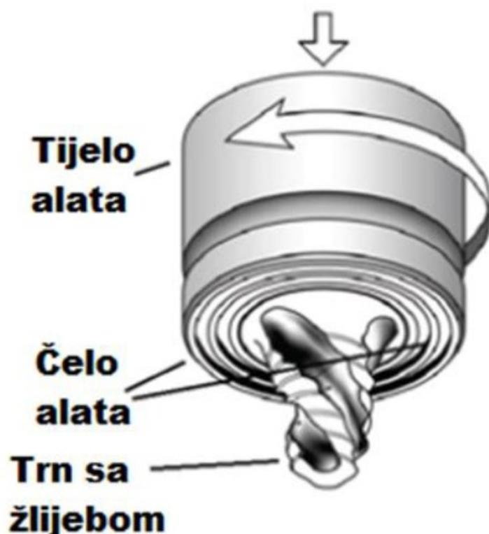
Slika 13. Alat za zavarivanje FSW postupkom [10]
