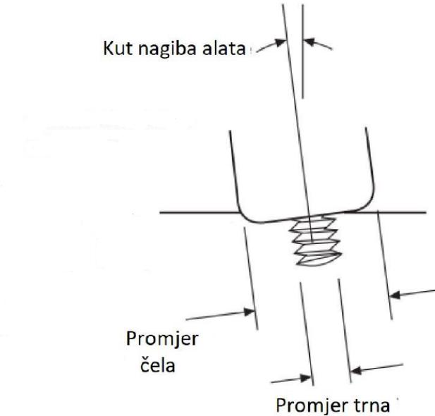
Slika 5. Promjer čela alata, promjer trna alata, kut nagiba alata [8]
