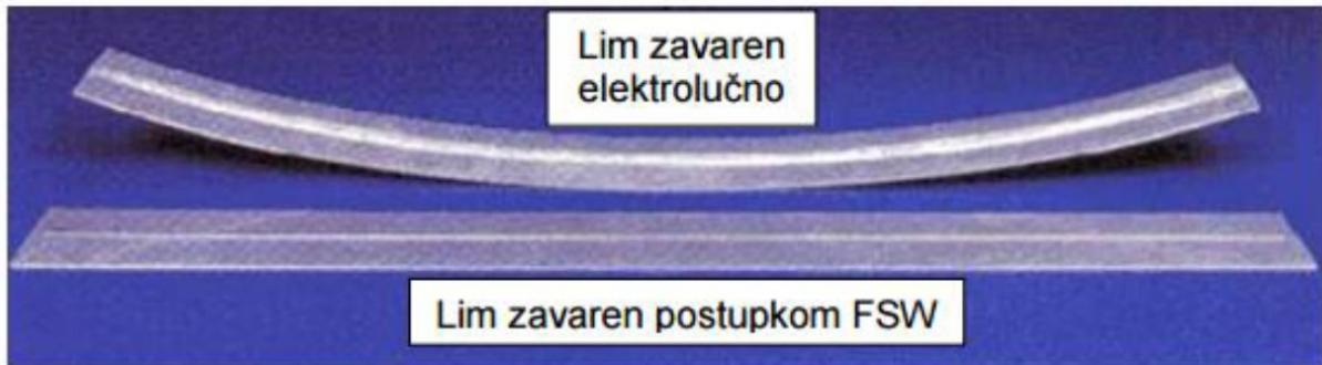
Slika 8. Distorzije limova zavarenih elektrolučnim postupkom u usporedbi sa FSW postupkom zavarivanja [11]
