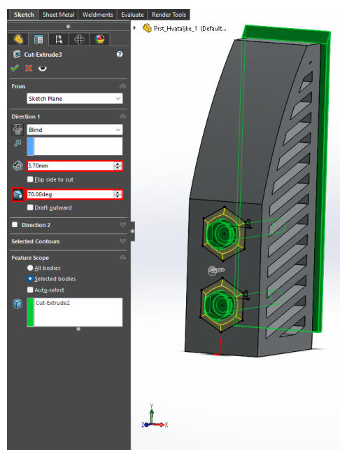
Slika 5.18. Proces zakošenja glave vijka
