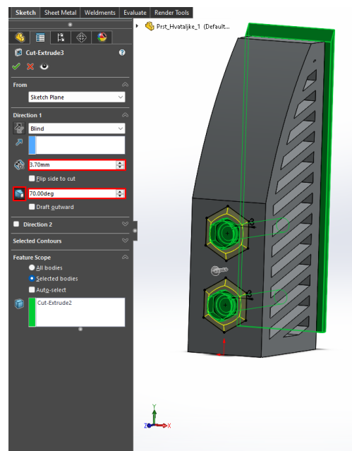
Slika 5.18. Proces zakošenja glave vijka
