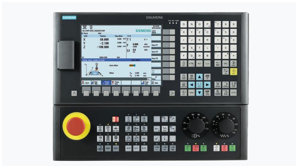
Slika 2.5. Računalna upravljačka jedinica za programiranje CNC alatnog stroja [9]
