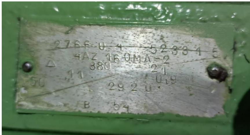
Slika 2.8. Natpisna pločica s nazivnim podacima pogonskog elektromotora
