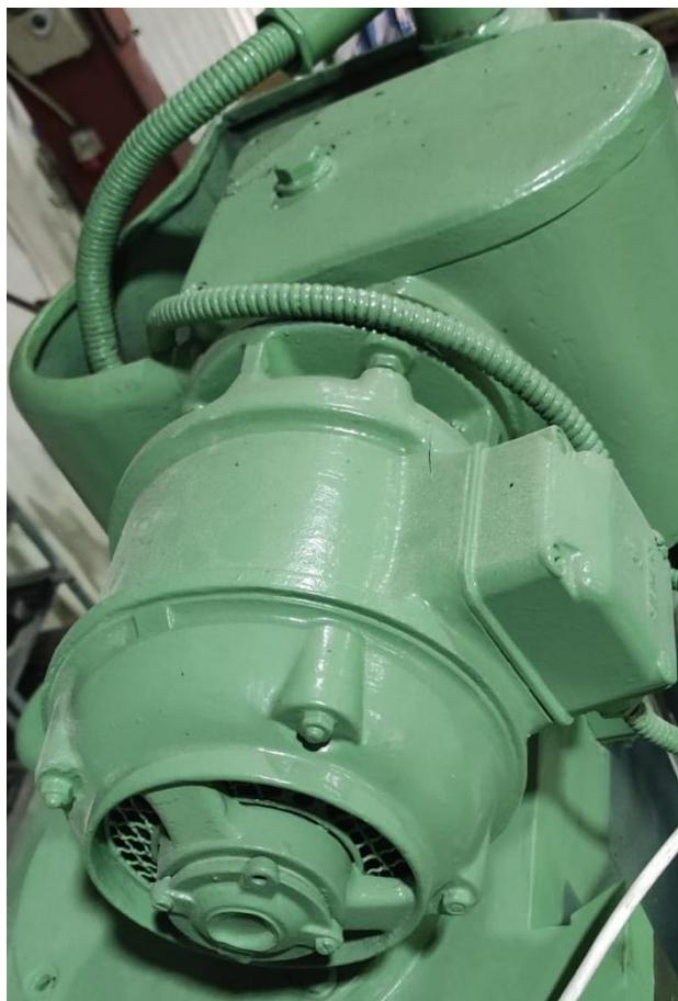
Slika 2.13. Elektromotor za pokretanje konzole
