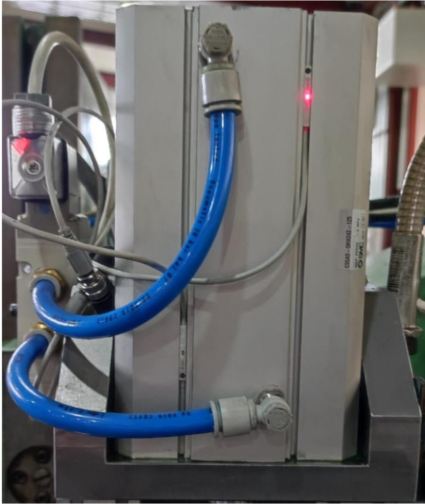
Slika 5.4. Reed prekidači za bilježenje položaja cilindra kod dizanja i spuštanja alata tijekom radnog i povratnog hoda
