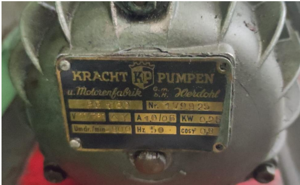
Slika 2.6. Natpisna pločica s nazivnim podacima pumpe za vodilice
