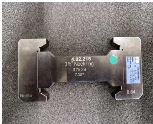
Slika 21: Kalibar za visinu prizme. [24]
