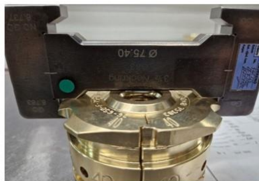
Slika 41: Kontrola visine i promjera prizme. [19] [24] [24]
