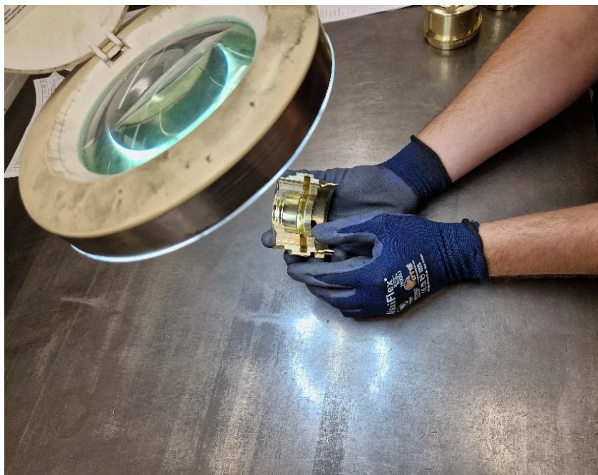
Slika 31: Kontrola oštećenja i poroznosti. [24]
