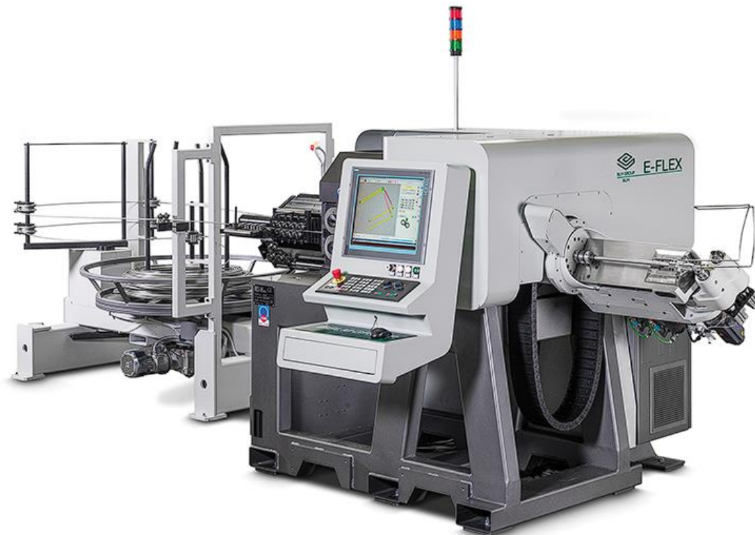
Slika 5.3: BLM group E-FLEX CNC stroj za savijanje žice [23]
