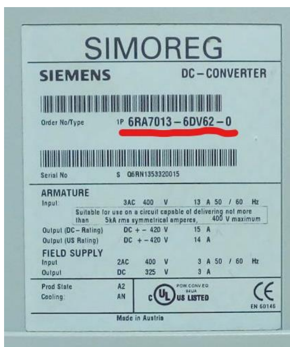
Slika 19. Pločica SIMOREG uređaja korištenog u laboratoriju
