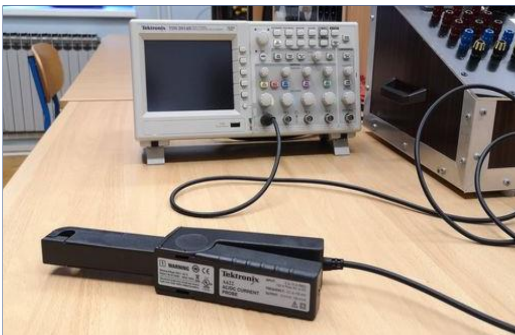
Slika 52. Osciloskop i strujna kliješta Tektronix
