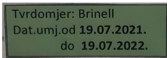
Slika 12. Primjer interne naljepnice ispravnosti opreme [13]
