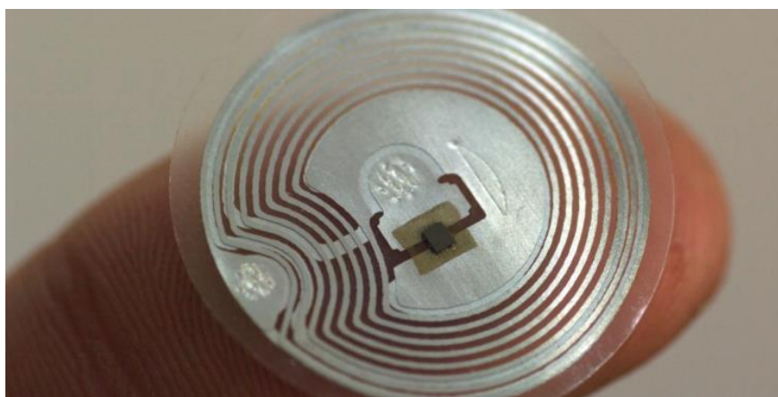
Slika 20: RFID čip Izvor [41]
