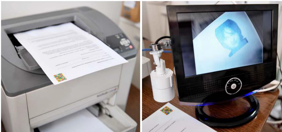
Slika 29: Infracrveni ispis na pisač i sustav detekcije originalnih dokumenata Izvor [47]
